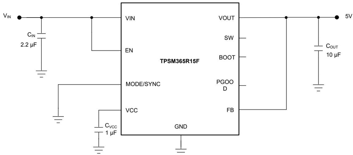
図 8-3. 5-V Output Design Example
