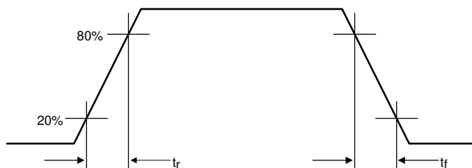
図 5-5. Output Rise and Fall Times
