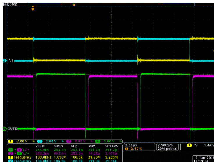
図 8-5. INA/B と OUTA/B のベンチ テスト波形
