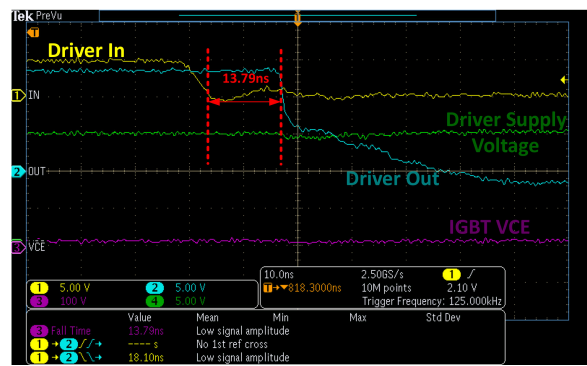
図 7-3. 昇圧コンバータの IGBT 駆動に使用されている UCC27624-Q1
