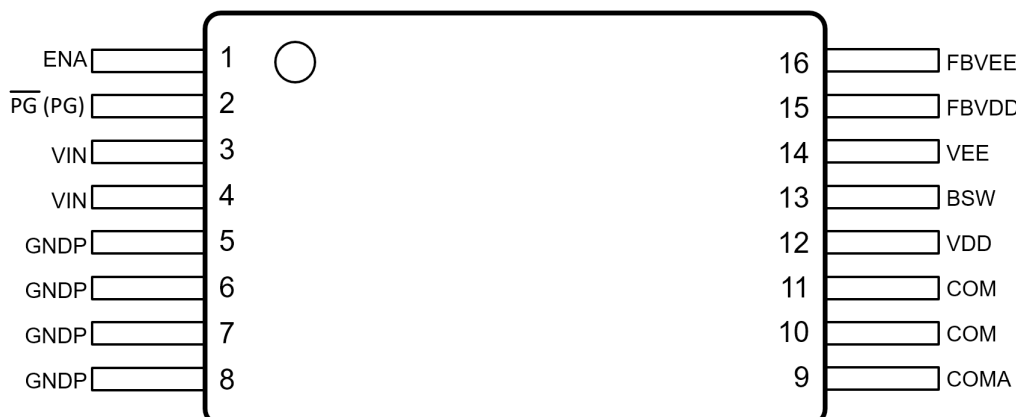
図 5-1. DHA パッケージ、16 ピン SSOP (上面図)
