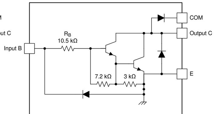
図 7-3. ULN2004A と LQ2004A のブロック図
