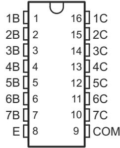
図 4-1. D、N、NS、PW パッケージ 16 ピン SOIC、PDIP、SO、TSSOP 上面図
