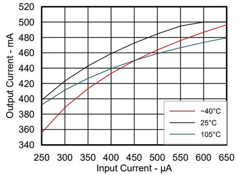
図 5-8. 最小出力電流と入力電流との関係
