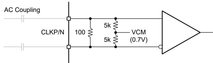
図 7-7. 内部サンプリングクロック回路
