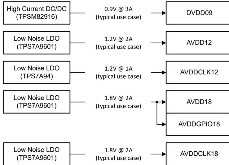
図 8-11. 電源レールとレギュレータの例
