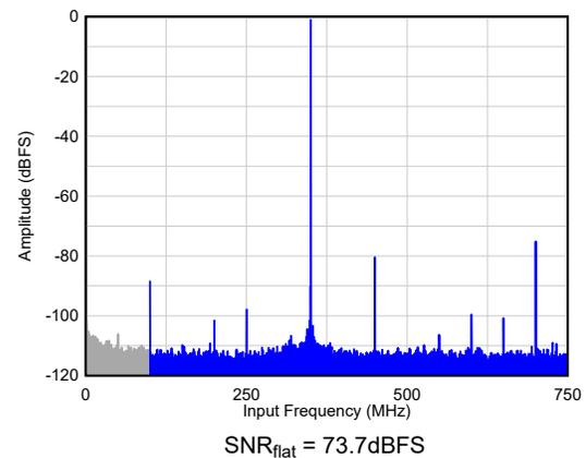
図 5-2.  $F_{IN} = 300\text{MHz}$  でのシングル トーン FFT
