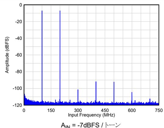
図 5-6.  $F_{IN} = 100/200\text{MHz}$  での 2 トーン FFT
