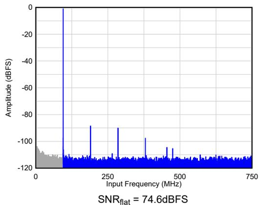
図 5-1.  $F_{IN} = 100\text{MHz}$  でのシングル トーン FFT
