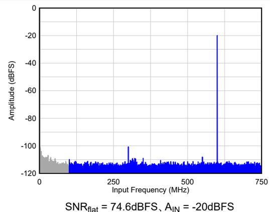
図 5-4.  $F_{IN} = 900\text{MHz}$  でのシングル トーン FFT
