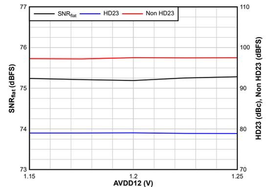
図 5-18. AC 性能と  $\text{AVDD12}$  電源との関係
