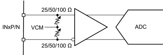
図 7-1. アナログ入力 (内部) 電気回路
