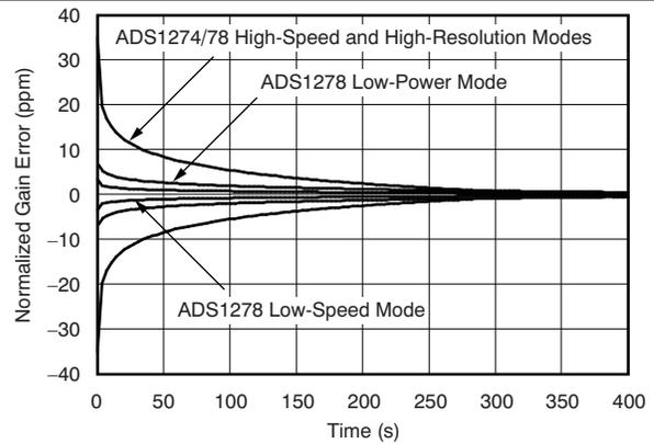
Figure 30. Gain Warmup Drift Response Band
