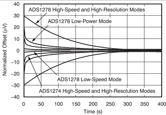
Figure 29. Offset Warmup Drift Response Band
