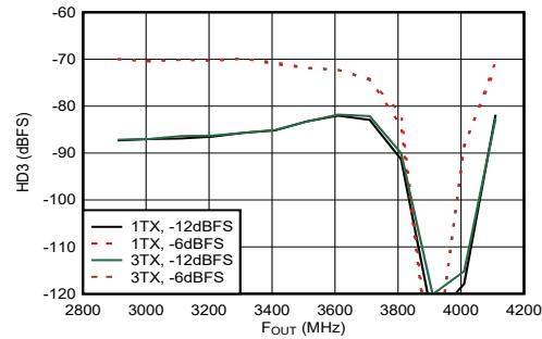
3.5GHz で整合、 $f_{\text{DAC}} = 11.79648\text{GSPS}$ 、インターリープ モード、高調波周波数での出力電力で正規化。ディップは、DC 付近での HD3 の低下に起因するものです。
