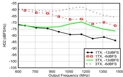
0.8GHz で整合、 $f_{\text{DAC}} = 8847.36\text{GSPS}$ 、ストレート モード。
