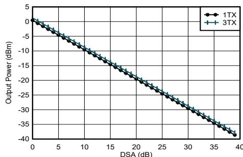
$A_{\text{out}} = -0.5\text{dFBS}$ 、3.5GHz 整合あり、PCB とケーブルの損失を含む。
