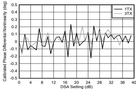
図 4-196. TX DSA 較正済み位相の微分非直線性 (8.11GHz)
