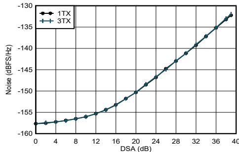
A.  $f_{\text{DAC}} = 11796.48\text{MSPS}$ 、インターリープ モード、3.5GHz で整合、 $A_{\text{OUT}} = -13\text{dBFS}$ 。
