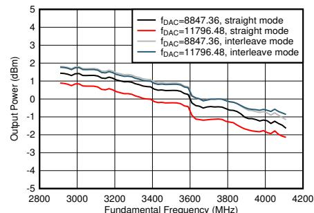
$A_{\text{out}} = -0.5\text{dFBS}$ 、3.5GHz 整合あり、PCB とケーブルの損失を含む。
