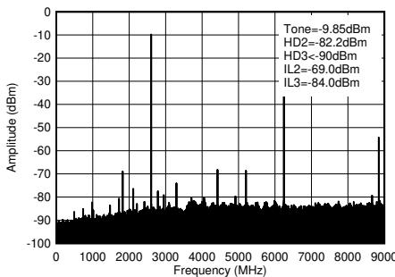
$f_{\text{DAC}} = 8847.36\text{MSPS}$ 、ストレート モード、2.6GHz 整合あり、PCB とケーブルの損失を含む。 $\text{IL}_n = f_s/n \pm f_{\text{OUT}}$  (デジタル クロックとのミキシングに起因)。
