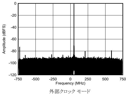
図 4-440. RX 単一トーン出力 FFT (8.11GHz、-1dBFS)
