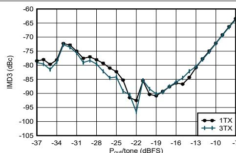
$f_{\text{DAC}} = 11796.48\text{MSPS}$ 、インターリープモード、 $f_{\text{CENTER}} = 0.85\text{GHz}$ 、 $f_{\text{SPACING}} = 20\text{MHz}$ 、0.8GHzで整合
