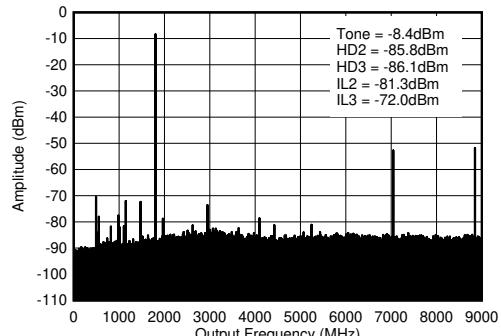
$f_{\text{DAC}} = 8847.36\text{MSPS}$ 、ストレート モード、1.8GHz 整合あり、PCB とケーブルの損失を含む。 $\text{IL}_n = f_{\text{S/n}} \pm f_{\text{OUT}}$  (デジタル クロックとのミキシングに起因)。
