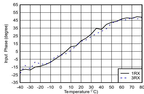
4.9GHz 整合あり、 $25^\circ\text{C}$  の位相で正規化
