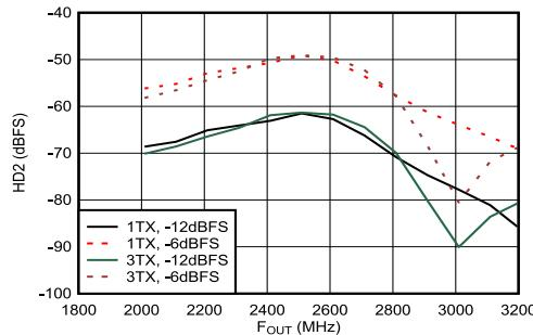
2.6GHz で整合、 $f_{\text{DAC}} = 11.79648\text{GSPS}$ 、インターリープ モード、高調波周波数での出力電力で正規化
