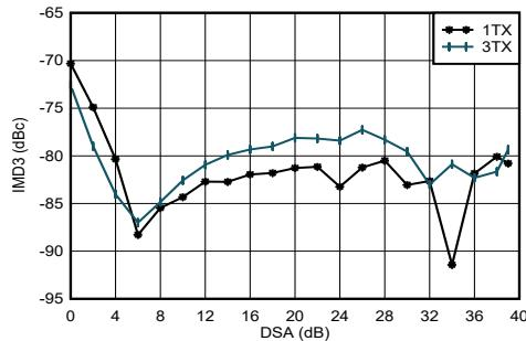
$f_{\text{DAC}} = 11796.48\text{MSPS}$ 、インターリープ モード、 $f_{\text{CENTER}} = 1.8\text{GHz}$ 、1.8GHz で整合、各トーン  $-13\text{dBFS}$
