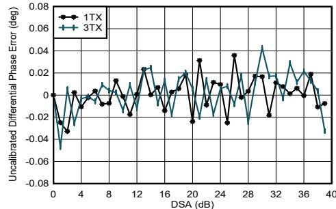
$f_{\text{DAC}} = 8847.36\text{MSPS}$ 、ストレート モード、2.6GHz で整合
