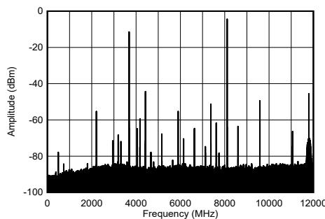
図 4-203. TX シングル トーン出力スペクトル (8.11GHz)
