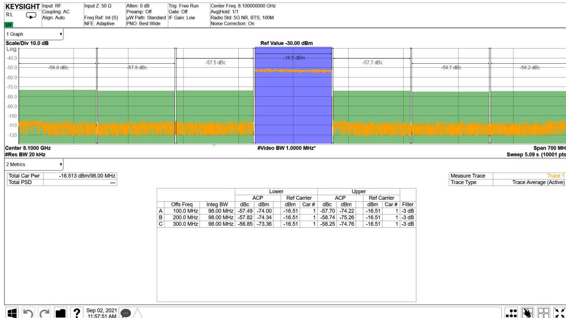
図 4-229. TX 100MHz NR 出力スペクトル (8.11GHz)
