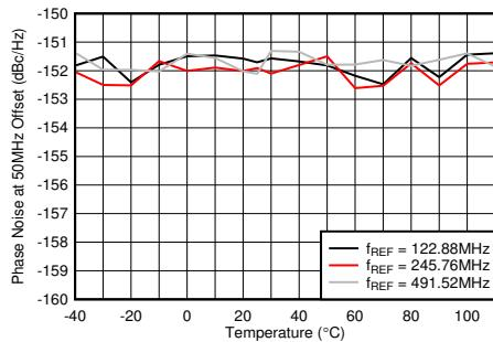
PLL イネーブル、 $f_{VCO} = 9830.4\text{MHz}$ 、TX 出力で測定
