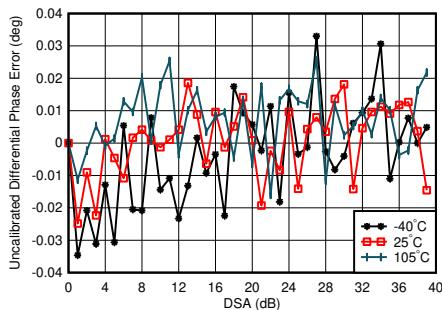
$f_{\text{DAC}} = 8847.36\text{MSPS}$ 、ストレート モード、2.6GHz で整合、全 DSA 設定にわたって 25°Cでの誤差が中央値であるチャネル
