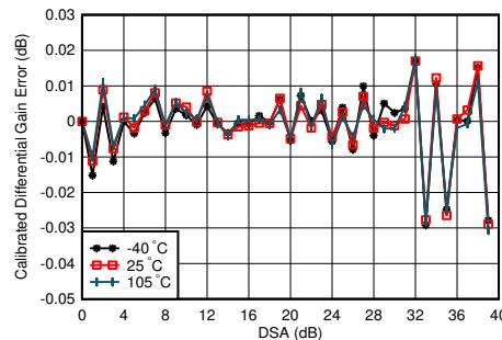
$f_{\text{DAC}} = 8847.36\text{MSPS}$ 、ストレート モード、2.6GHz で整合、全 DSA 設定にわたって 25°Cでの誤差が中央値であるチャネル 微分ゲイン誤差 =  $P_{\text{OUT}}(\text{DSA 設定} - 1) - P_{\text{OUT}}(\text{DSA 設定}) + 1$
