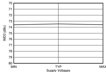
$f_{\text{DAC}} = 11796.48\text{MSPS}$ 、インターリープ モード、2.6GHz 整合あり。トーンから 40MHz オフセット。出力電力 = -13dBFS。すべての電源電圧に最小値、代表値、最大値がある。
