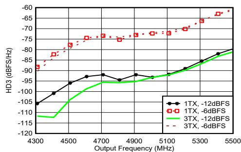
4.9GHz で整合、 $f_{\text{DAC}} = 11.79648\text{GSPS}$ 、インターリープモード、高調波周波数での出力電力で正規化
