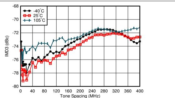
$f_{\text{DAC}} = 11796.48\text{MSPS}$ 、インターリープモード、 $f_{\text{CENTER}} = 1.8\text{GHz}$ 、1.8GHzで整合、各トーン -13dBFS、ワーストチャネル
