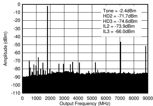
$f_{\text{DAC}} = 8847.36\text{MSPS}$ 、ストレート モード、1.8GHz 整合あり、PCB とケーブルの損失を含む。 $\text{IL}_n = f_s/n \pm f_{\text{OUT}}$  (デジタル クロックとのミキシングに起因)。
