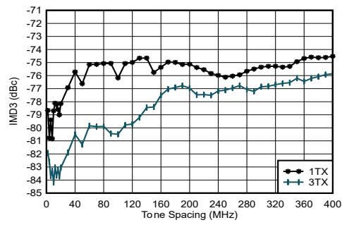
$f_{\text{DAC}} = 11796.48\text{MSPS}$ 、インターリープ モード、 $f_{\text{CENTER}} = 0.85\text{GHz}$ 、0.8GHz で整合、各トーン -13dBFS
