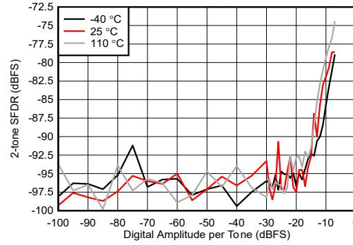
図 4-439. RX 2 トーン SFDR とデジタル振幅との関係 (8.11GHz)
