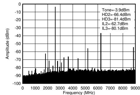
$f_{\text{DAC}} = 8847.36\text{MSPS}$ 、ストレート モード、2.6GHz 整合あり、PCB とケーブルの損失を含む。 $\text{IL}_n = f_s/n \pm f_{\text{OUT}}$  (デジタル クロックとのミキシングに起因)。
