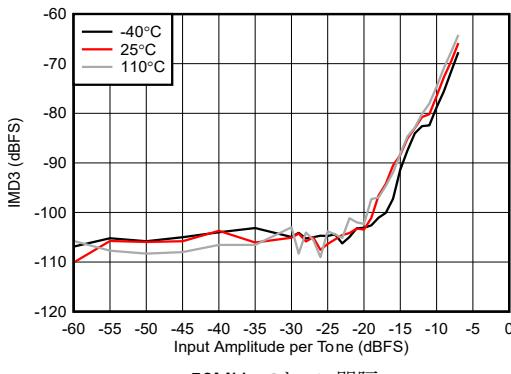
図 4-428. RX IMD3 と入力振幅との関係 (8.11GHz)
