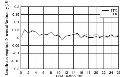
図 4-236. TX DSA 未較正振幅の微分非直線性
