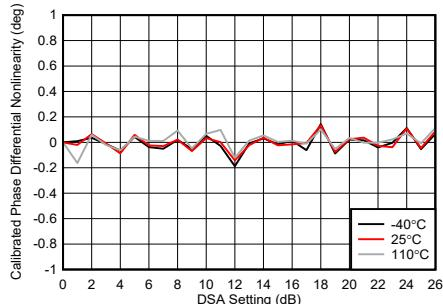
図 4-249. TX DSA 較正済み位相の積分非直線性
