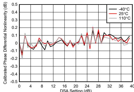
図 4-198. TX DSA 較正済み位相の微分非直線性 (8.11GHz)
