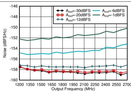
2.6GHzで整合、シングルトーン、 $f_{\text{DAC}} = 11.79648\text{GSPS}$ 、インターリープモード、40MHzオフセット
