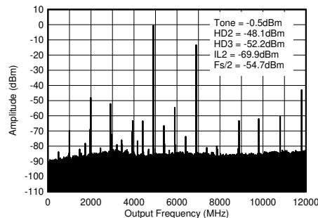
$f_{\text{DAC}} = 11796.48\text{MSPS}$ 、インターリープ モード、4.9GHz 整合あり、PCB とケーブルの損失を含む。ILn =  $f_s/n \pm f_{\text{OUT}}$ 。
