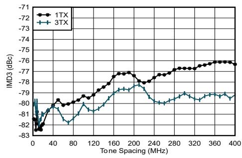
$f_{\text{DAC}} = 8847.36\text{MSPS}$ 、ストレート モード、 $f_{\text{CENTER}} = 0.85\text{GHz}$ 、0.8GHz で整合、各トーン -13dBFS
