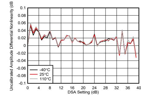
図 4-189. TX DSA 未較正振幅の微分非直線性 (8.11GHz)
