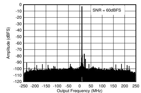
4.9GHz 整合あり、 $f_{\text{IN}} = 4910\text{MHz}$ 、 $A_{\text{IN}} = -3\text{dBFS}$
