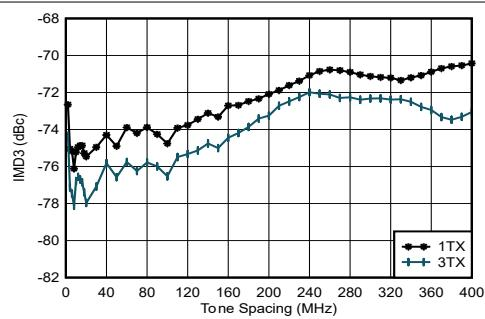
$f_{\text{DAC}} = 5898.24\text{MSPS}$ 、ストレート モード、 $f_{\text{CENTER}} = 0.85\text{GHz}$ 、0.8GHz で整合、各トーン -13dBFS
