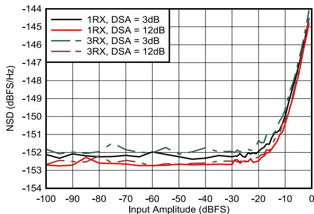
図 4-432. RX NSD とデジタル振幅との関係 (8.11GHz)
