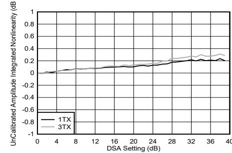
図 4-191. TX DSA 未較正振幅の積分非直線性 (8.11GHz)
