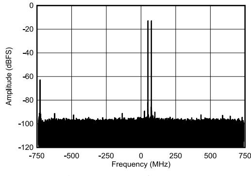
図 4-445. RX デュアル トーン出力 FFT (8.11GHz)
