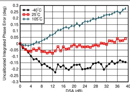
$f_{\text{DAC}} = 8847.36\text{MSPS}$ 、ストレート モード、2.6GHz で整合、全 DSA 設定にわたって 25°Cでの誤差が中位の大きさのチャネル
