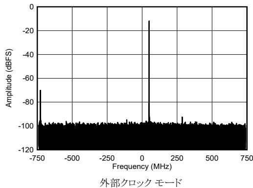
図 4-441. RX 単一トーン出力 FFT (8.11GHz、-12dBFS)
