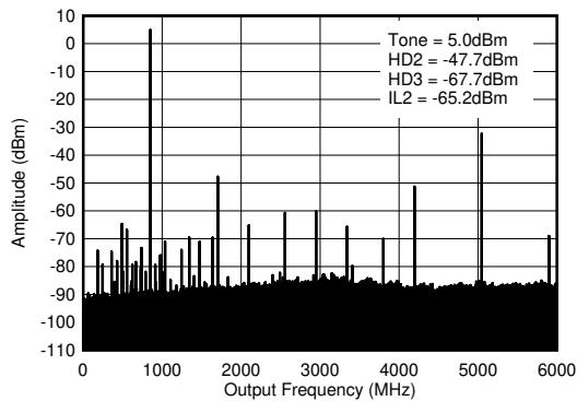
$f_{\text{DAC}} = 5898.24\text{MSPS}$ 、インターリープ モード、0.8GHz 整合あり、PCB とケーブルの損失を含む。ILn =  $f_s/n \pm f_{\text{OUT}}$ 。
