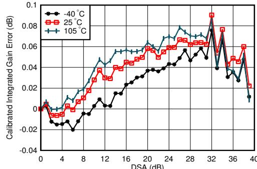
$f_{\text{DAC}} = 5898.24\text{MSPS}$ 、インターリープ モード、0.8GHz で整合
