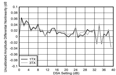
図 4-187. TX DSA 未較正振幅の微分非直線性 (8.11GHz)
