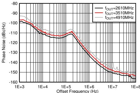
PLL イネーブル、 $f_{VCO} = 9830.4\text{MHz}$ ,  $f_{REF} = 491.52\text{MSPS}$ , TX 出力で測定
