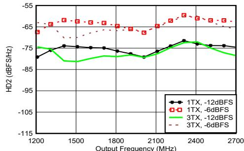
1.8GHz で整合、 $f_{\text{DAC}} = 11.79648\text{GSPS}$ 、インターリープ モード、高調波周波数での出力電力で正規化
