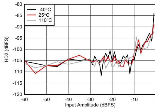
図 4-435. RX HD2 とデジタル振幅との関係 (8.11GHz)
