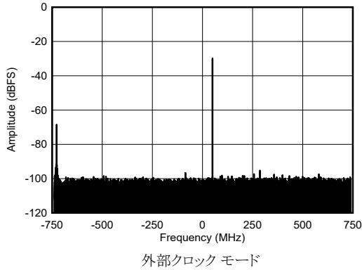
図 4-442. RX 単一トーン出力 FFT (8.11GHz、-30dBFS)
