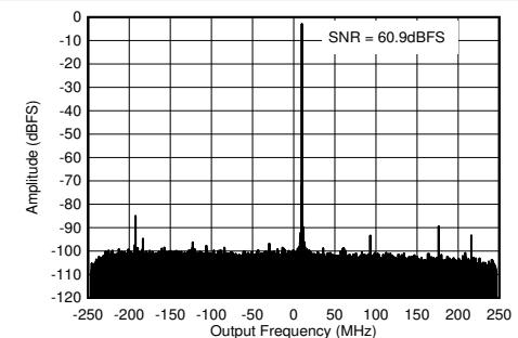
1.8GHz 整合あり、 $f_{\text{IN}} = 2610\text{MHz}$ 、 $A_{\text{IN}} = -3\text{dBFS}$
