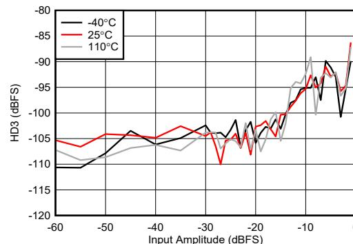
図 4-437. RX HD3 とデジタル振幅との関係 (8.11GHz)
