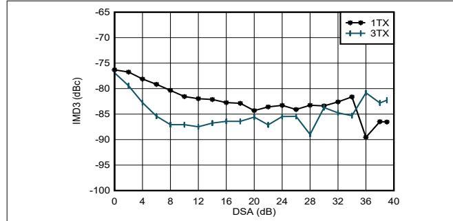
$f_{\text{DAC}} = 5898.24\text{MSPS}$ 、インターリープ モード、0.8GHz で整合
