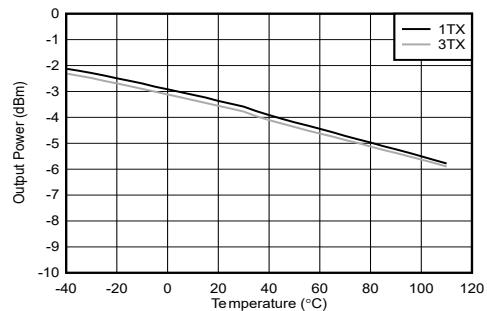
PCB とケーブルの損失を含む。
