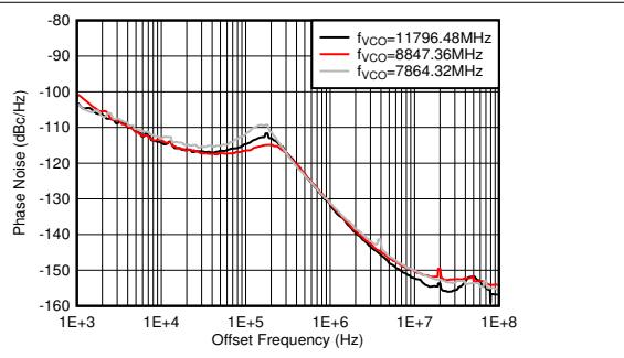
PLL イネーブル、 $f_{\text{REF}} = 491.52\text{MSPS}$ 、TX 出力で測定
