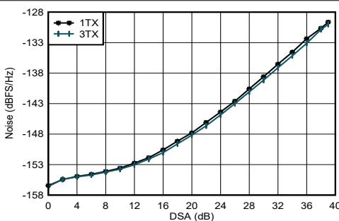
$f_{\text{DAC}} = 11796.48\text{MSPS}$ 、インターリープ モード、4.9GHz で整合、
