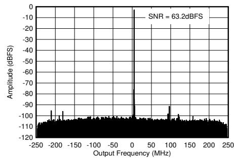
0.8GHz 整合あり、 $f_{\text{IN}} = 840\text{MHz}$ 、 $A_{\text{IN}} = -3\text{dBFS}$
