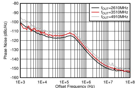
PLL イネーブル、 $f_{VCO} = 9830.4\text{MHz}$ ,  $f_{REF} = 491.52\text{MSPS}$ , TX 出力で測定
