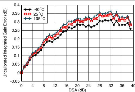
$f_{\text{DAC}} = 8847.36\text{MSPS}$ 、ストレート モード、2.6GHz で整合、全 DSA 設定にわたって 25°Cでの誤差が中央値であるチャネル 積分ゲイン誤差 =  $P_{\text{OUT}}(\text{DSA 設定}) - P_{\text{OUT}}(\text{DSA 設定} = 0) + (\text{DSA 設定})$
