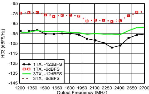
1.8GHz で整合、 $f_{\text{DAC}} = 11.79648\text{GSPS}$ 、インターリープ モード、高調波周波数での出力電力で正規化
