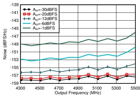
4.9GHz で整合、シングル トーン、 $f_{\text{DAC}} = 11.79648\text{GSPS}$ 、インターリープ モード、40MHz オフセット、DSA = 0dB
