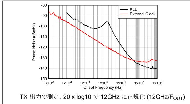
TX 出力で測定、 $20 \times \log_{10}$  で  $12\text{GHz}$  に正規化 ( $12\text{GHz}/F_{\text{OUT}}$ )
