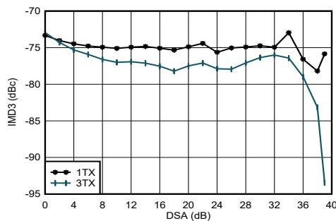
$f_{\text{DAC}} = 8847.36\text{MSPS}$ 、ストレート モード、 $f_{\text{CENTER}} = 2.6\text{GHz}$ 、2.6GHz で整合、各トーン -13dBFS
