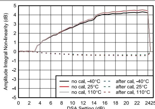
図 4-425. RX 振幅の積分非直線性 (8.11GHz)
