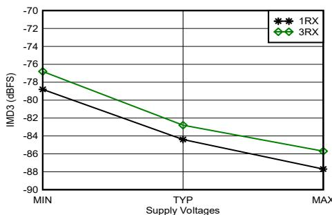
3.6GHz 整合あり、各トーン -7dBFS、20MHz のトーン間隔、すべての電源電圧は推奨動作条件の最小値、代表値、最大値
