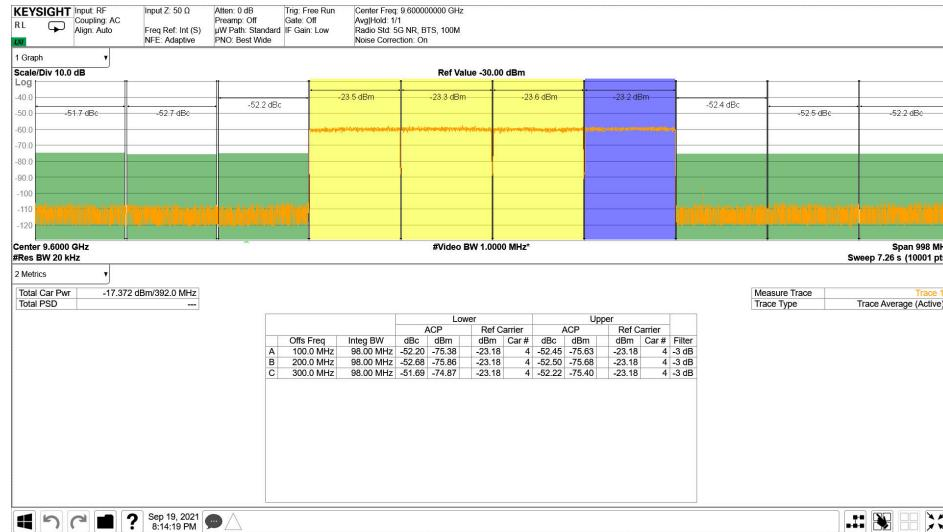
PCB とケーブルの損失を含む。
