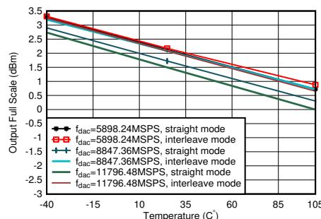
$A_{\text{OUT}} = -0.5\text{dBFS}, 1.8\text{GHz}$  に整合
