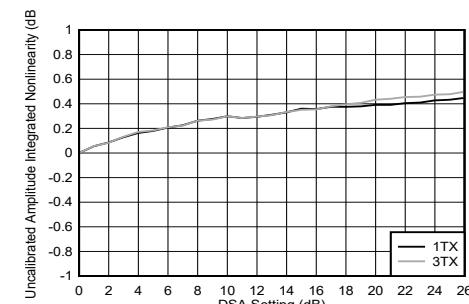
図 4-240. TX DSA 未較正振幅の積分非直線性
