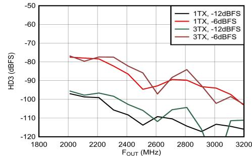
2.6GHz で整合、 $f_{\text{DAC}} = 11.79648\text{GSPS}$ 、インターリープ モード、高調波周波数での出力電力で正規化
