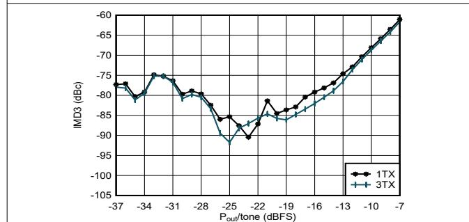
$f_{\text{DAC}} = 11796.48\text{MSPS}$ 、インターリープモード、 $f_{\text{CENTER}} = 1.8\text{GHz}$ 、 $f_{\text{SPACING}} = 20\text{MHz}$ 、1.8GHzで整合
