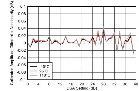
図 4-190. TX DSA 較正済み振幅の微分非直線性 (8.11GHz)
