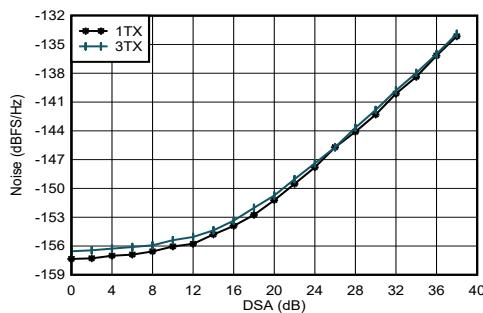
$f_{\text{DAC}} = 8847.36\text{MSPS}$ 、ストレート モード、2.6GHz で整合、 $P_{\text{OUT}} = -13\text{dBFS}$
