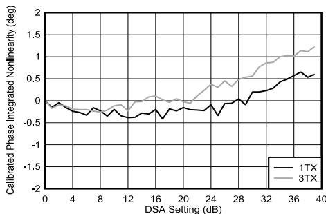
図 4-200. TX DSA 較正済み位相の積分非直線性 (8.11GHz)
