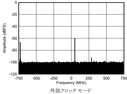
図 4-443. RX 単一トーン出力 FFT (8.11GHz、-60dBFS)
