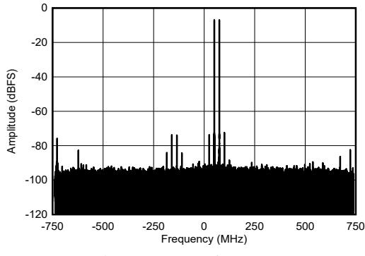
図 4-444. RX デュアル トーン出力 FFT (8.11GHz)
