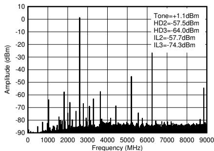
$f_{\text{DAC}} = 8847.36\text{MSPS}$ 、ストレート モード、2.6GHz 整合あり、PCB とケーブルの損失を含む。 $IL_n = f_{\text{S/n}} \pm f_{\text{OUT}}$  (デジタル クロックとのミキシングに起因)。
