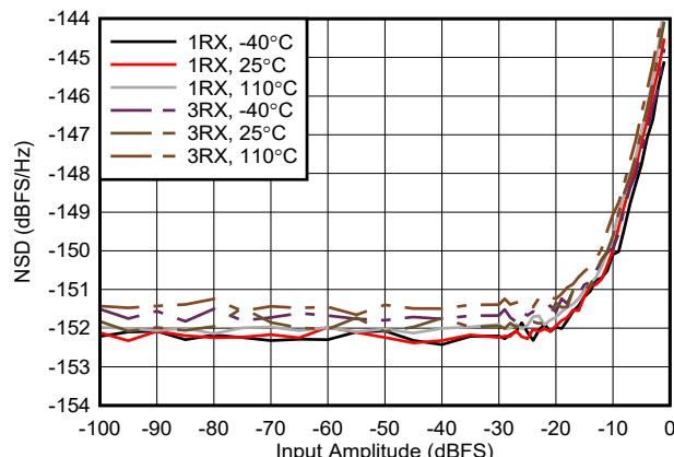
図 4-431. RX NSD とデジタル振幅との関係 (8.11GHz)
