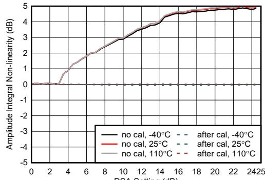
図 4-451. RX 振幅の積分非線形性 (9.6GHz)
