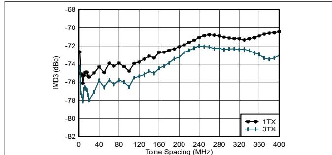
$f_{\text{DAC}} = 11796.48\text{MSPS}$ 、インターリープモード、 $f_{\text{CENTER}} = 1.8\text{GHz}$ 、1.8GHzで整合、各トーン -13dBFS
