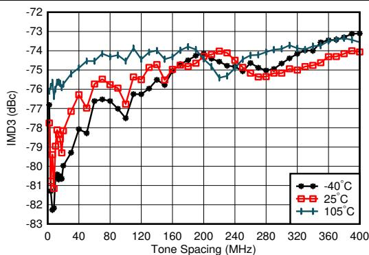
$f_{\text{DAC}} = 11796.48\text{MSPS}$ 、ストレートモード、 $f_{\text{CENTER}} = 0.85\text{GHz}$ 、
