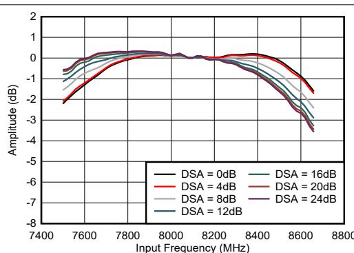
1RX および 3RX、8.11GHz で正規化
