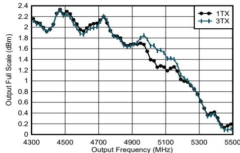
PCB とケーブルの損失を除く。 $A_{\text{OUT}} = -0.5\text{dBFS}$ 、DSA = 0、4.9GHz 整合あり。
