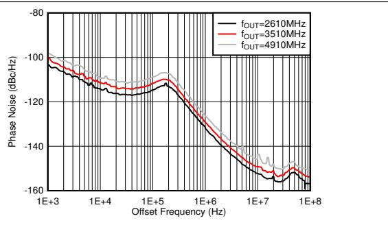
PLL イネーブル、 $f_{\text{VCO}} = 11796.48\text{MHz}$ 、 $f_{\text{REF}} = 491.52\text{MSPS}$ 、
