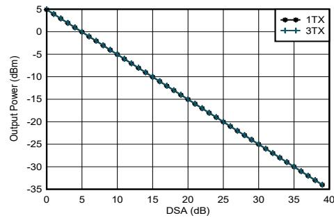
$f_{\text{DAC}} = 11796.48\text{MSPS}$ 、インターリーブ モード、 $A_{\text{out}} = -0.5\text{dBFS}$ 、0.8GHz に整合
