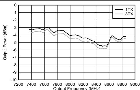
PCB とケーブルの損失を含む。
