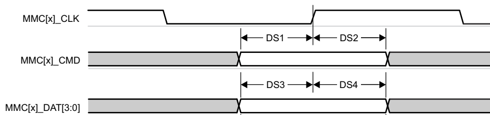
図 6-86. MMC1/MMC2 – デフォルト速度 – 受信モード
