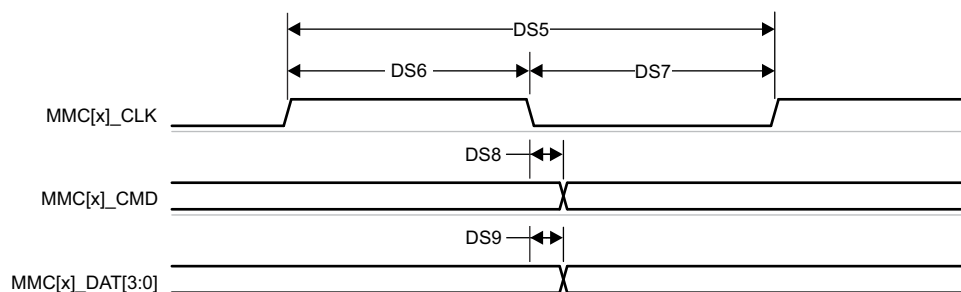
図 6-86. MMC1/MMC2 – デフォルト速度 – 送信モード
