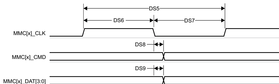
図 6-91. MMC1/MMC2 – デフォルト速度 – 送信モード
