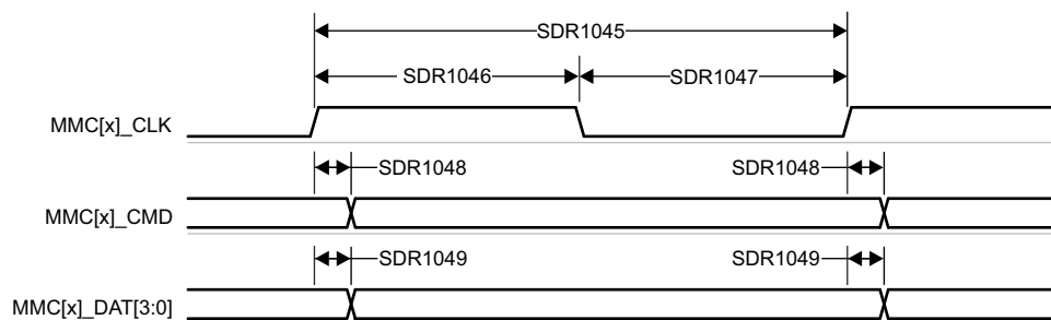
図 6-87. MMC1/MMC2 – UHS-I SDR104 – 送信モード
