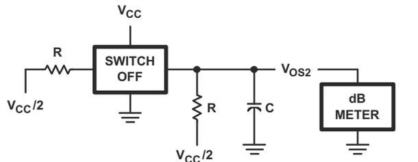
図 6-3. 2つのスイッチ間のクロストークテスト回路
