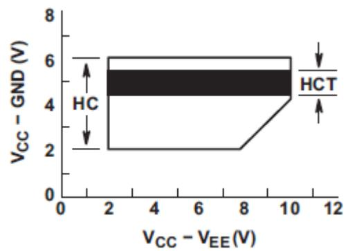
図 5-2. ( $V_{CC} - GND$ ) に応じた推奨動作領域
