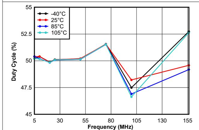
図 6-11. デューティ サイクルと周波数および温度との関係 (3.3V 電源、容量性負荷なし、通常モードのデバイス)
