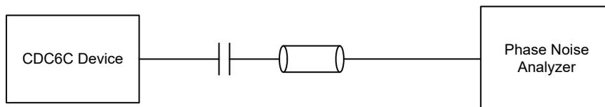
図 7-2. CDC6Cx の出力位相ノイズテスト構成
