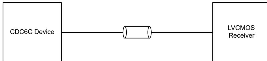
図 8-1. LVCMOS レシーバへの CDC6Cx の出力
