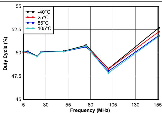
図 6-12. デューティ サイクルと周波数および温度との関係 (2.5V 電源、容量性負荷なし、通常モードのデバイス)
