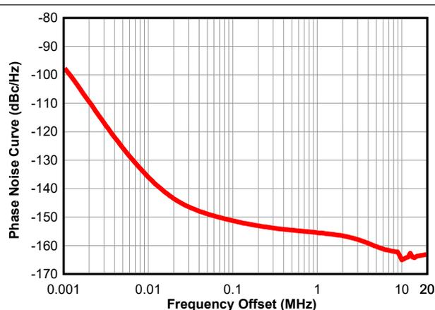
図 6-10. 25MHz、25°C、3.3V 電源での位相ノイズ曲線
