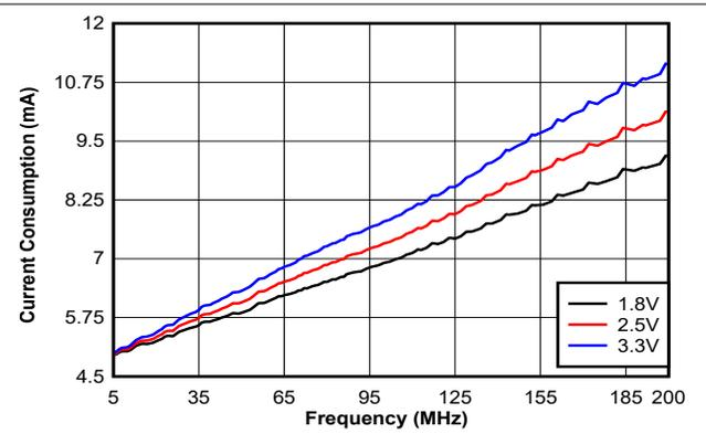
図 6-6. 25°C での消費電流と周波数および電源電圧との関係
