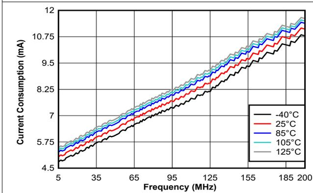
図 6-5. 3.3V 電源での消費電流と周波数および温度との関係
