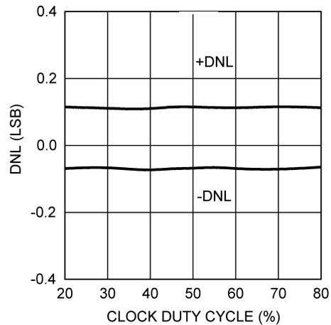
图 5-11. 5V DNL vs Clock Duty Cycle
