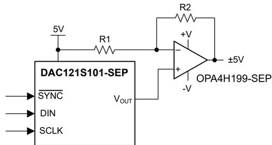
**図 7-1. Bipolar Operation**
