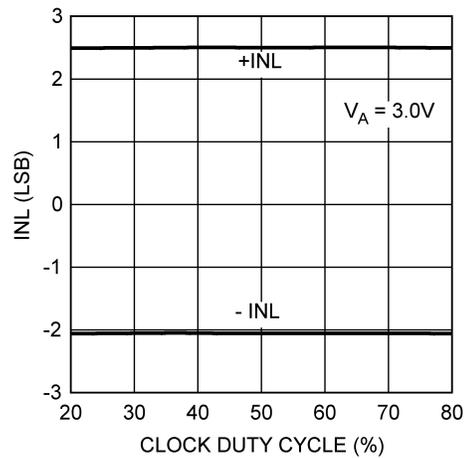
图 5-15. 3V INL vs Clock Duty Cycle
