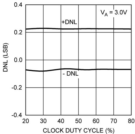
图 5-10. 3V DNL vs Clock Duty Cycle
