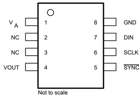
図 4-1. DAC121S101-SEP DGK Package, 8-Pin VSSOP (Top View)
