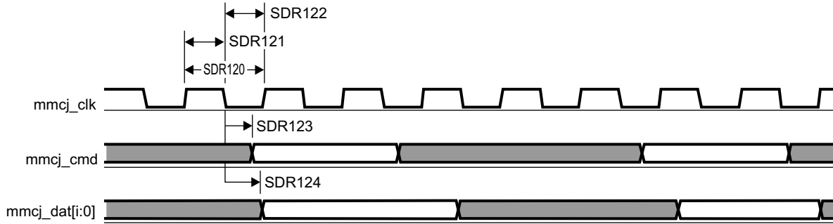
图 5-104. MMC/SD/SDIOj in - SDR12 - Transmitter Mode
