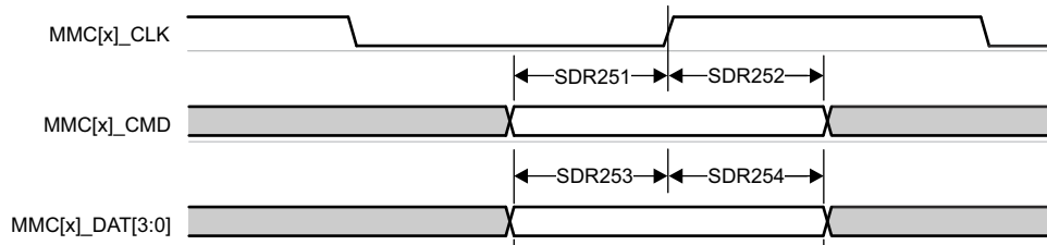
図 6-106. MMC1/2 – UHS-I SDR25 – 受信モード
