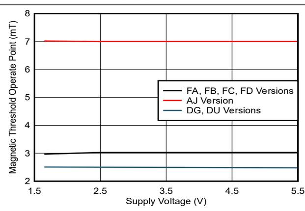
図 6-6.  $|B_{OP}|$  と  $V_{CC}$  との関係
