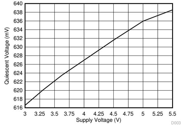
図 5-2. 静止電圧と電源電圧との関係
