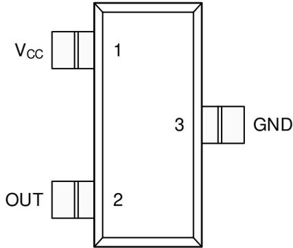
図 4-1. DBZ パッケージ 3 ピン SOT-23 上面図
