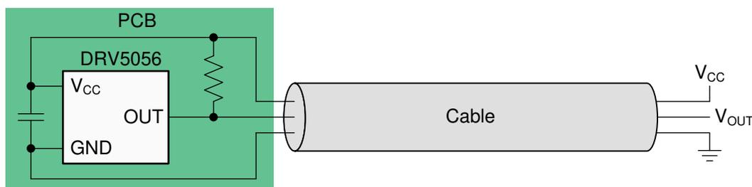
図 7-1. ワイヤ故障検出回路
