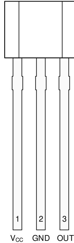
図 4-2. LPG パッケージ 3 ピン TO-92 上面図
