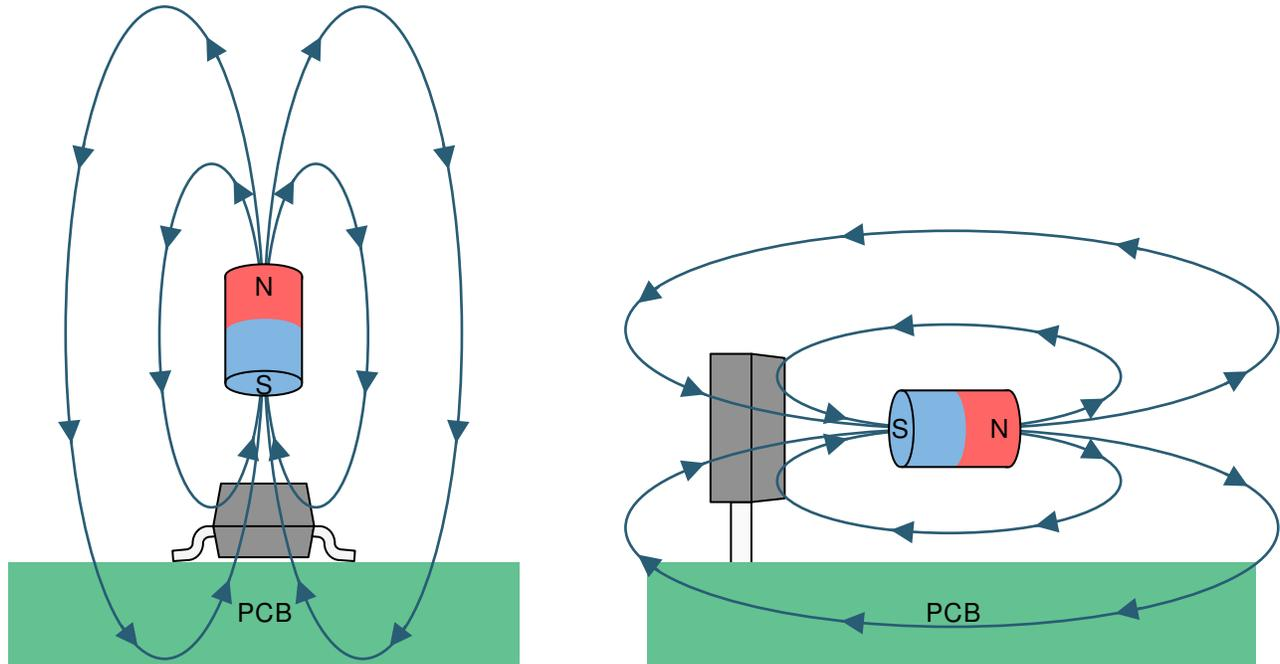
図 6-2. 正の B の磁束の方向
