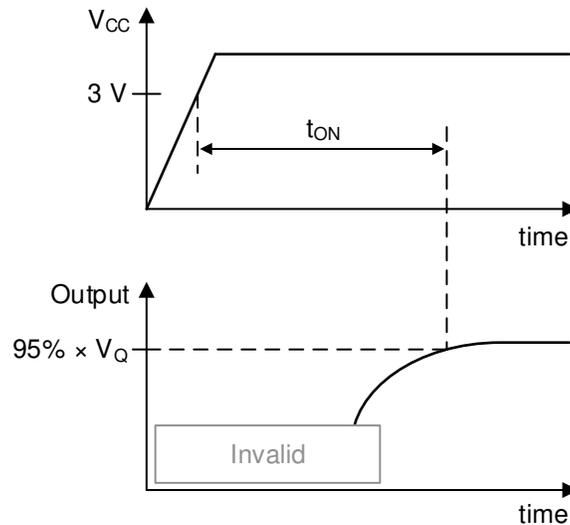
図 6-4.  $t_{ON}$  の定義
