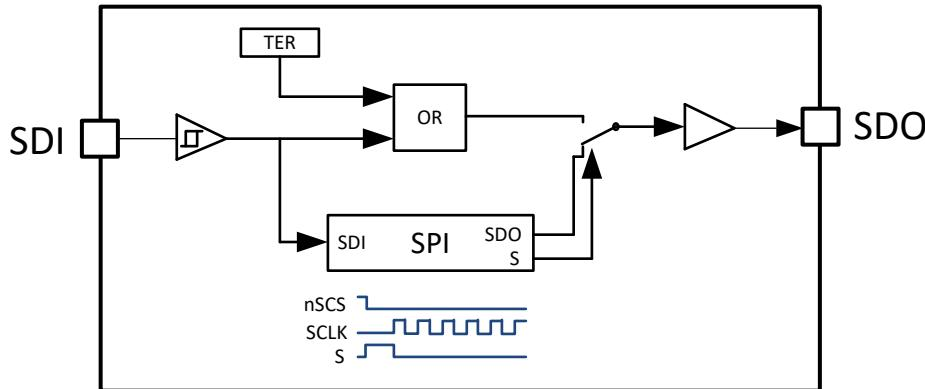
図 7-23. TER ビットの組み合わせロジック
