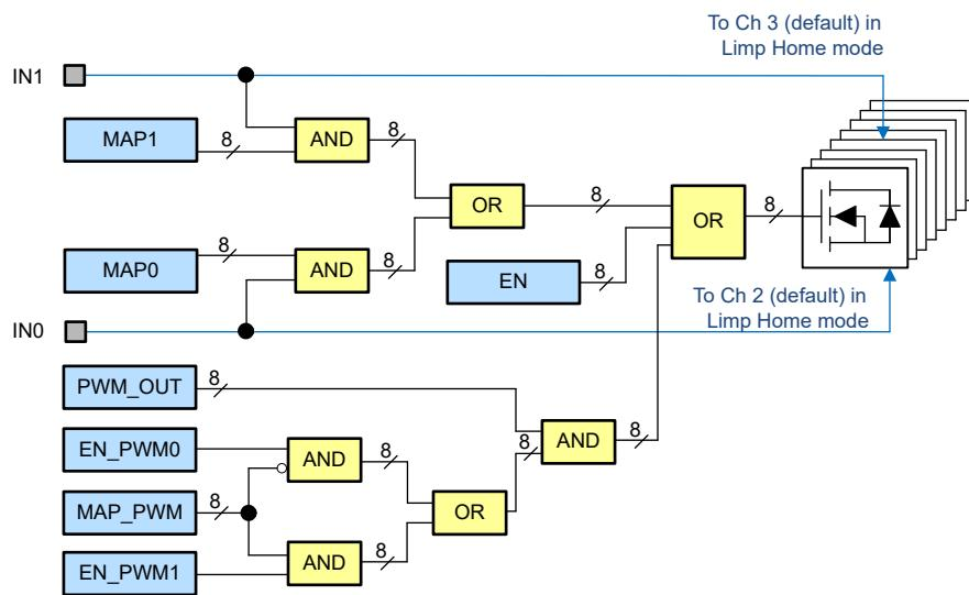
図 7-11. PWM ジェネレータのマッピング
