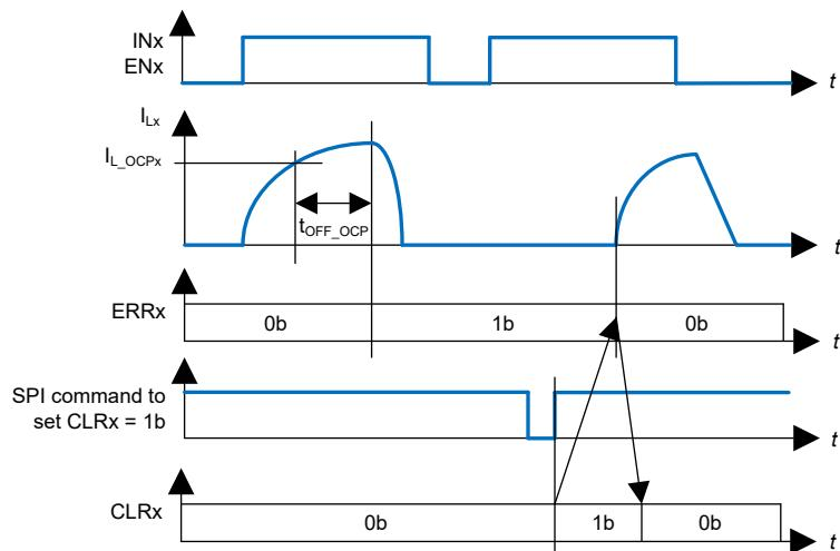
図 7-14. 過電流時にラッチオフする
