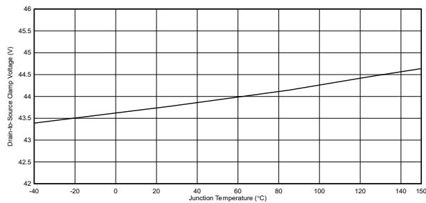
図 6-5. ドレイン-ソース間クランプ電圧
