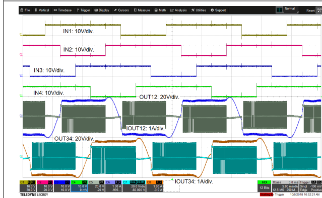
図 8-9. ステッピングモータのハーフステッピング動作、オフ状態時ブレーキ
