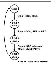
図 7-13. BIST Mode Flow Diagram
