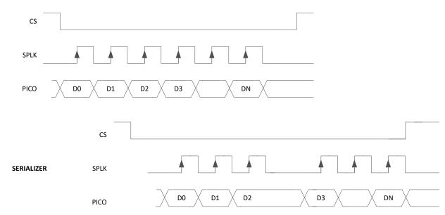
図 7-4. Reverse Channel SPI Write
