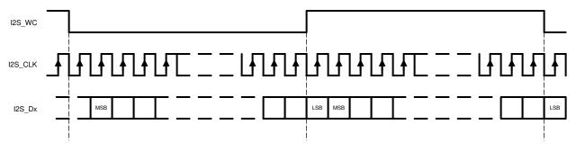
図 7-8. I2S Frame Timing Diagram
