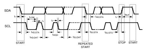
図 6-11. Serial Control Bus Timing Diagram
