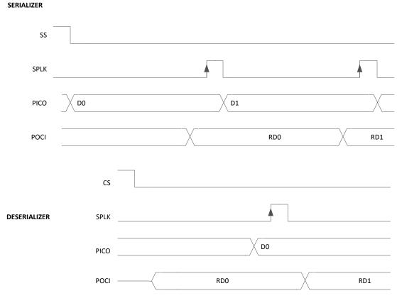
図 7-3. Forward Channel SPI Read
