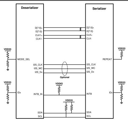
図 7-11. HDCP Repeater Connection Diagram
