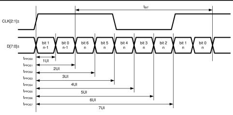
図 6-10. FPD-Link Transmitter Pulse Positions
