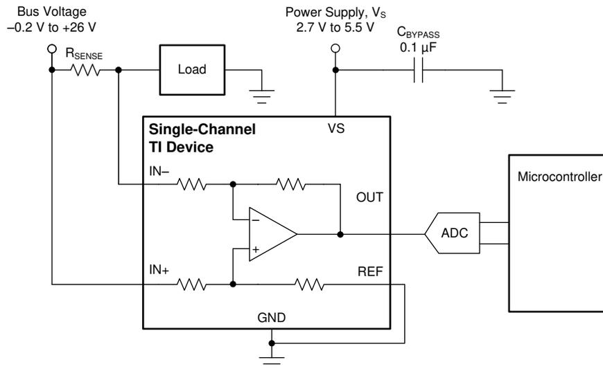
注: デバイスと A/D コンバータ (ADC) の間のグラウンド オフセット誤差を除去するため、REF ピンを ADC リファレンス入力に接続してからグラウンドに接続します。最高の性能を得るには、INAx181 の出力と ADC の間に RC フィルタを使用します。詳細については、『ZOUT を使用した負荷誘起アンプの安定性に関する問題の閉ループ解析』アプリケーションレポートを参照してください。
