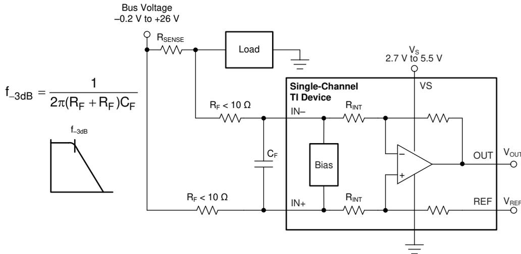
図 8-2. 入力ピンでのフィルタリング
