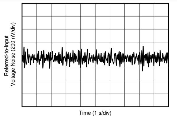
図 6-30. 0.1Hz~10Hz の電圧ノイズ (入力換算)
