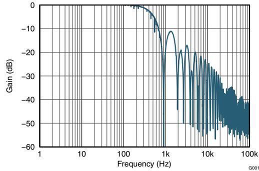
変換時間 = 1.052ms、変換は 1 回のみ
