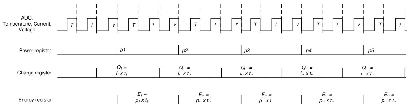
図 7-2. 電力、エネルギー、充電の計算方法
