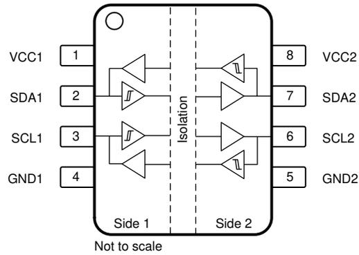
图 5-1. ISO1540 D Package 8-Pin SOIC Top View
