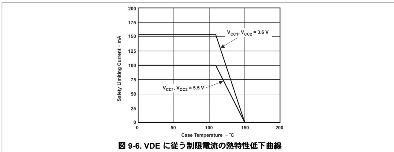
図 9-6. VDE に従う制限電流の熱特性低下曲線
