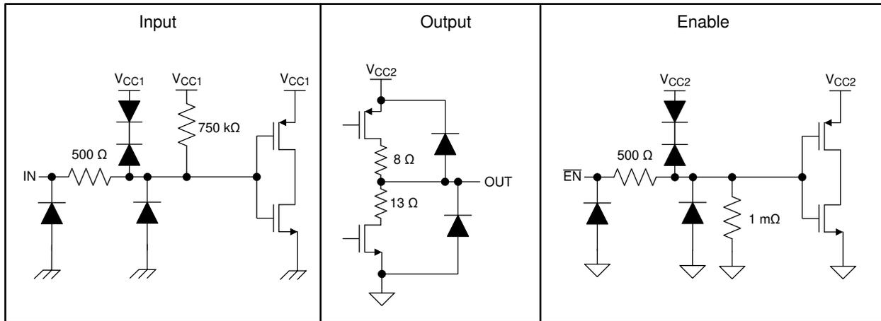
図 8-1. 等価な入力および出力回路図
