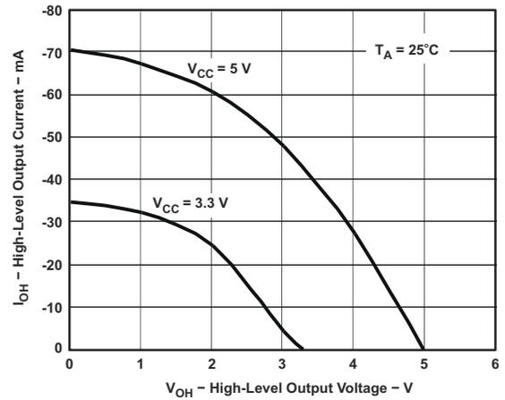
図 6-8. High レベル出力電流と High レベル出力電圧との関係
