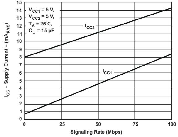
図 6-2. RMS 電源電流と信号速度との関係
