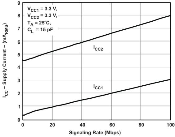
図 6-1. RMS 電源電流と信号速度との関係
