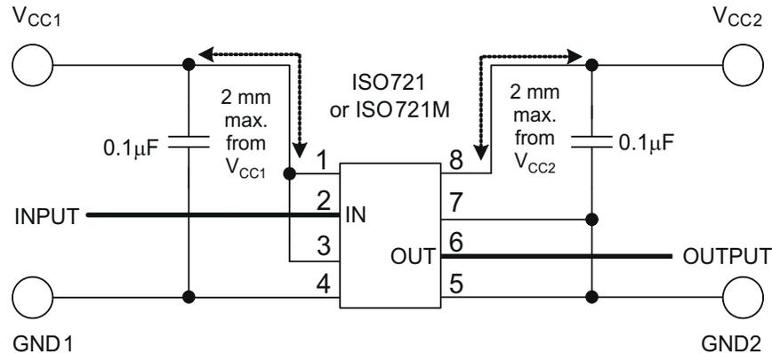
図 9-2. ISO721 の標準の回路接続図
