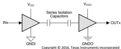
V<sub>CCI</sub> = 入力電源、V<sub>CCO</sub> = 出力電源
