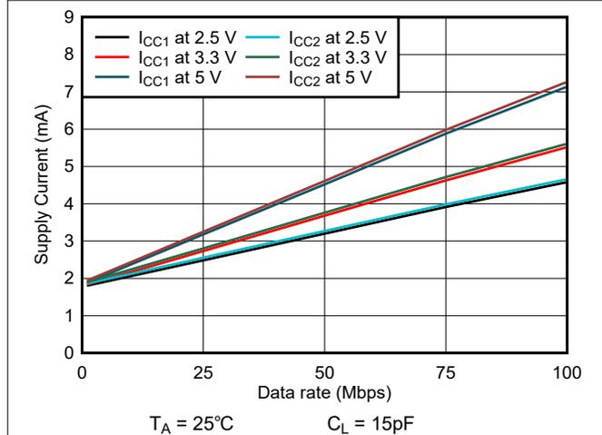
図 6-9. ISO7721 の電源電流とデータレートとの関係 (15pF 負荷時)
