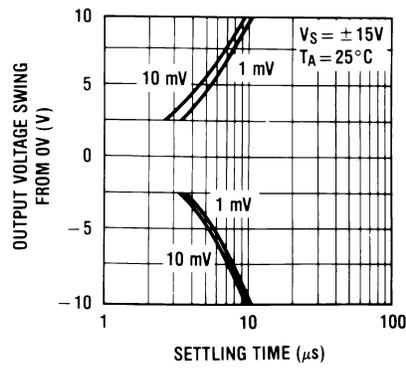
图 21. Inverter Settling Time
