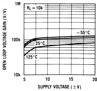
图 19. Open Loop Voltage Gain
