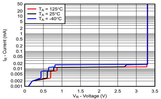
図 6-10. 最小動作電圧、 $V_R = 3.3V$
