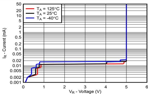
図 6-11. 最小動作電圧、 $V_R = 5V$
