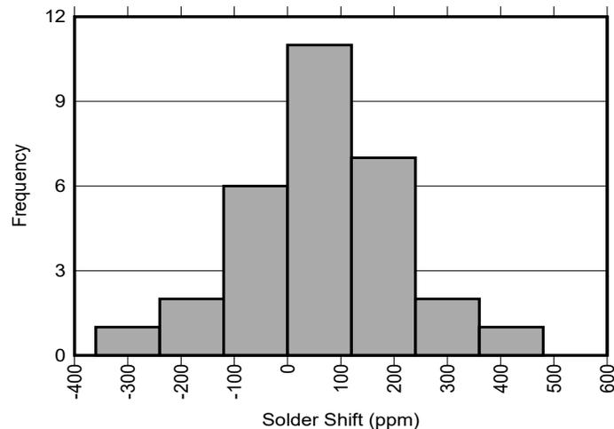
図 7-3. 半田付けの熱による変動、 $V_{REF}$  (%)
