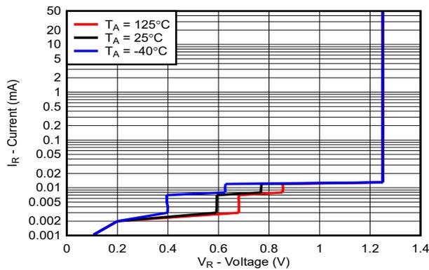
図 6-9. 最小動作電圧、 $V_R = 1.25V$
