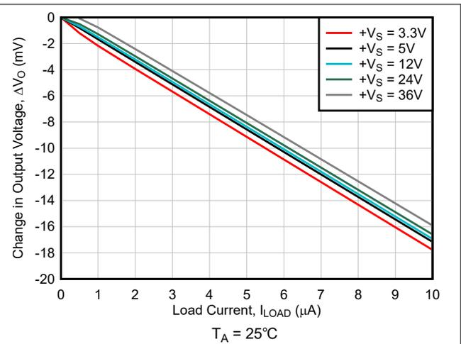
図 6-28. 出力電圧と負荷電流の関係の変化
