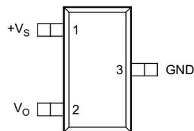
図 5-1. DBZ パッケージ 3 ピン SOT-23 上面図
