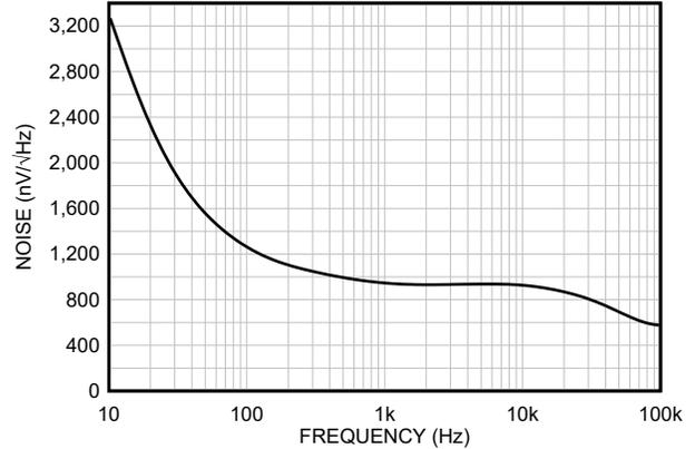
図 6-16. ノイズ電圧 (新チップ)
