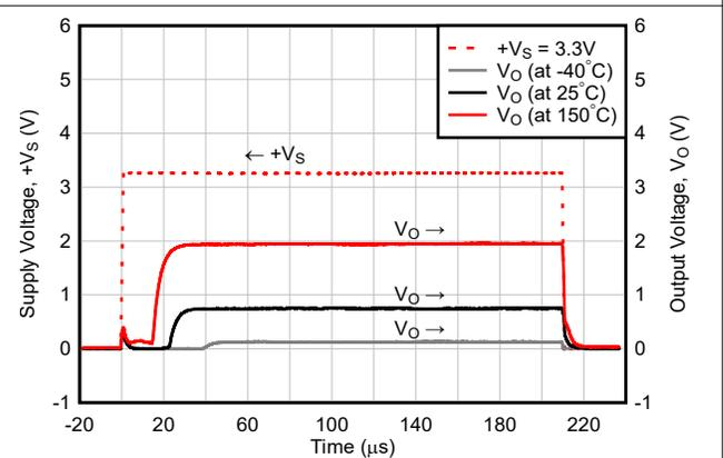
図 6-30.  $+V_S = 3.3\text{V}$  ステップへの起動応答 ( $t_r = 1\mu\text{s}$ ,  $C_{\text{Load}}$  および  $C_{\text{By-pass}}$  なし)
