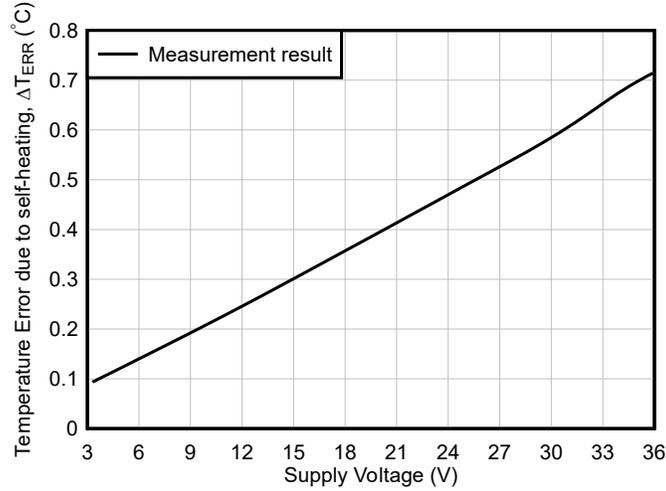
30 ゲージのワイヤに半田付けされたデバイス。この精度は、25°C でデバイスを常に 10 分間動作させた後で読み取られます。
