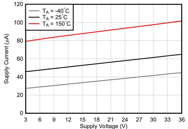
図 6-26. 電源電流と電源電圧との関係
