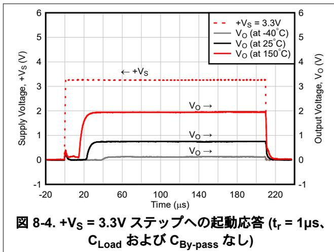
図 8-4. +V<sub>S</sub> = 3.3V ステップへの起動応答 (t<sub>r</sub> = 1μs、C<sub>Load</sub> および C<sub>By-pass</sub> なし)
