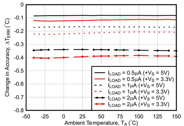
図 6-24. 精度と温度との関係の変化
