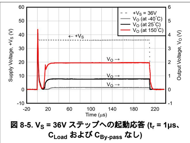
図 8-5. V<sub>S</sub> = 36V ステップへの起動応答 (t<sub>r</sub> = 1μs、C<sub>Load</sub> および C<sub>By-pass</sub> なし)
