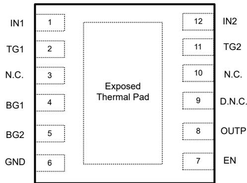
図 4-1. DRR Package, 12-Pin WSON (Top View)
