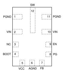
図 6-1. 12-Pin VQFN RNX Package (Top View)
