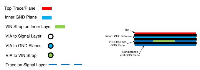
図 11-2. Example Layout for VQFN Package
