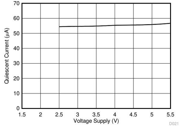
図 5-16. 静止電流と電源電圧との関係
