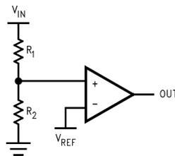
**Figure 24. Threshold Detector**
