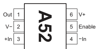
図 4-1. OPA300 SOT-23 パッケージ、6 ピン (上面図)
