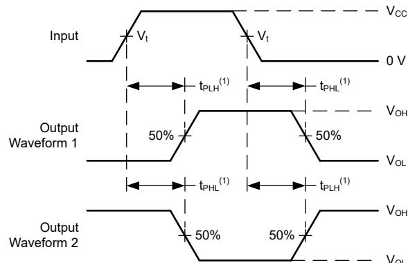
(1)  $t_{PLH}$  と  $t_{PHL}$  の大きい方が  $t_{pd}$  に相当します。
