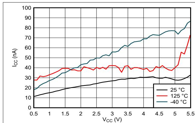
図 5-1. 電源電流と電源電圧との関係
