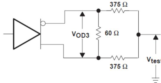
FIG 6-2. Driver  $V_{OD3}$
