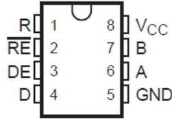
图 4-1. D or P Package (Top View)
