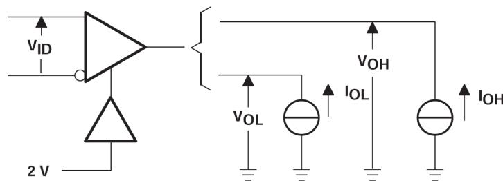
図 6-1.  $V_{OH}$  and  $V_{OL}$  Test Circuit
