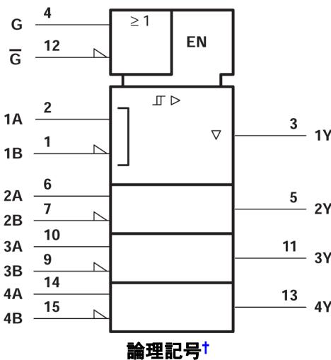
できます。このデバイスは、ITU 勧告 V.10、V.11、X.26、X.27 の仕様を満たしています。3 ステート出力機能により、入力がオープンの場合に出力が常に High になるようフェイルセーフ設計のバス構成システムに直接接続できます。
