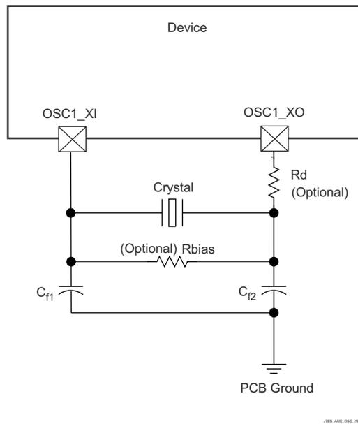
図 6-30. OSC1 水晶振動子の実装
