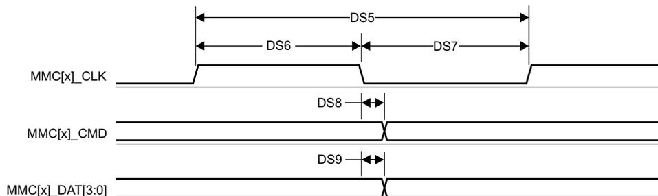
図 6-90. MMC1/2 – デフォルト速度 – 送信モード
