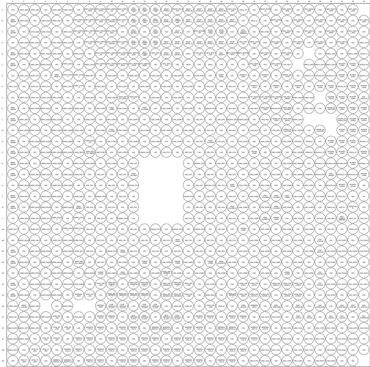
図 5-1. AND FCBGA-N1063 のピン配置図 (上面図)
