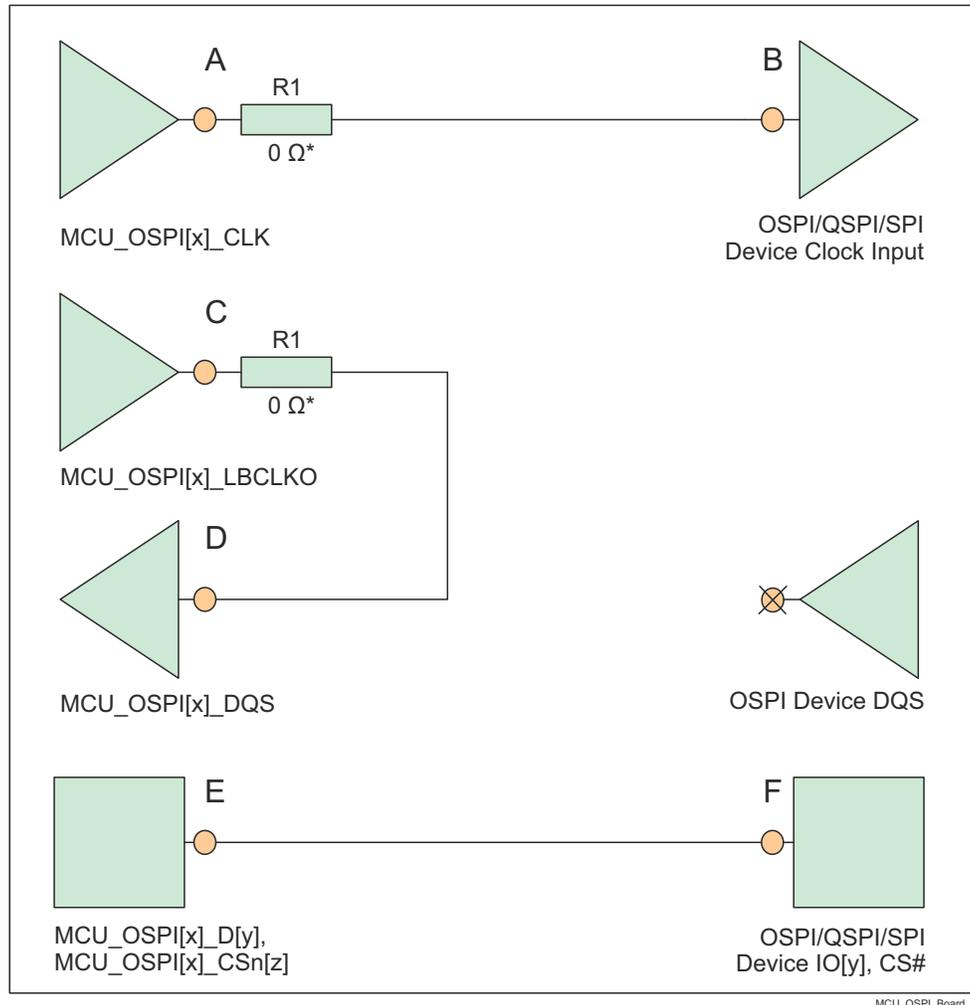
\* 0 Ω 抵抗 (R1) は、MCU\_OSPI[x]\_CLK ピンおよび MCU\_OSPI[x]\_LBCLKO ピンのできるだけ近くに配置して、必要に応じて微調整するためのプレースホルダです。
