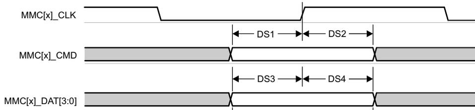
図 6-89. MMC1/2 – デフォルト速度 – 受信モード
