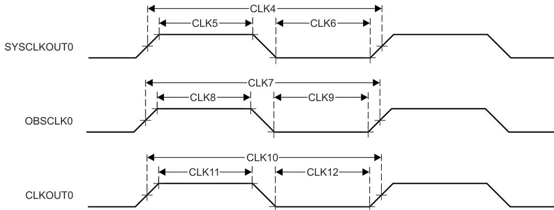
図 6-24. クロックのスイッチング特性
