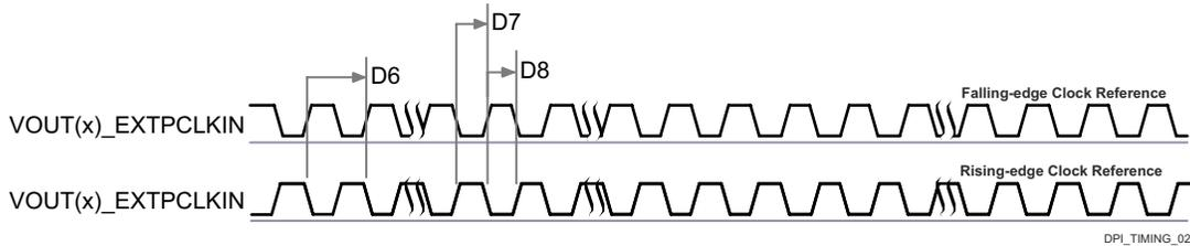
図 6-45. DPI 外部ピクセル クロック入力
