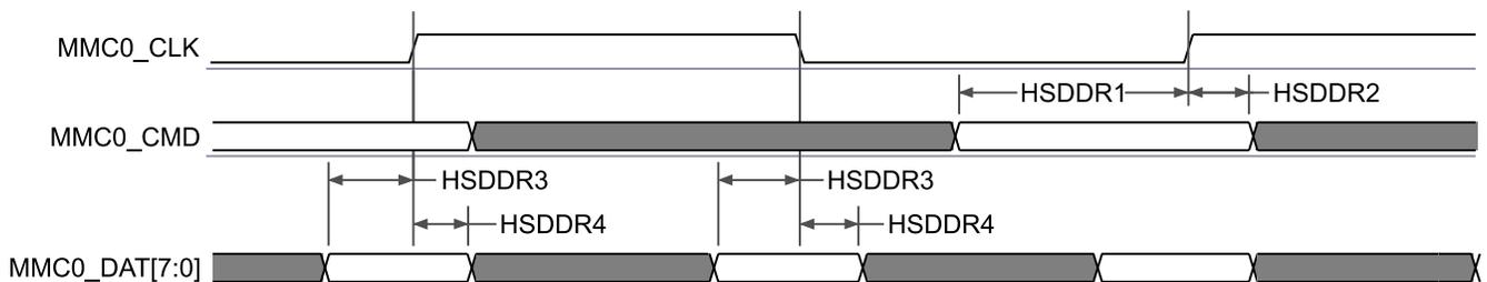
**図 6-83. MMC0 – 高速 DDR モード – 受信モード**
