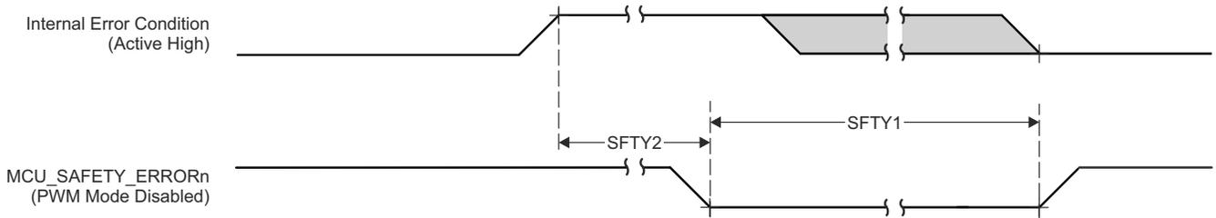
図 6-21. MCU\_SAFETY\_ERRORn のスイッチング特性
