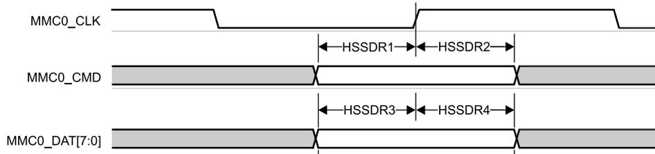
図 6-81. MMC0 – 高速 SDR モード – 受信モード
