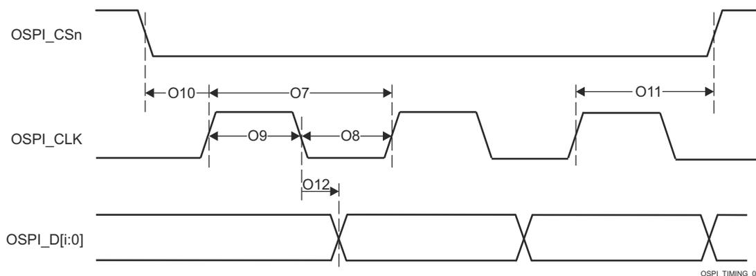
図 6-107. OSPI のスイッチング特性 – SDR
