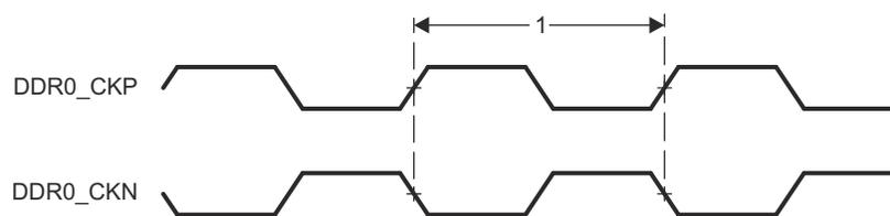
図 6-43. DDRSS メモリ インターフェイスのクロック タイミング
