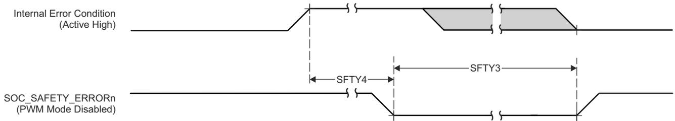
図 6-22. SOC\_SAFETY\_ERRORn のスイッチング特性
