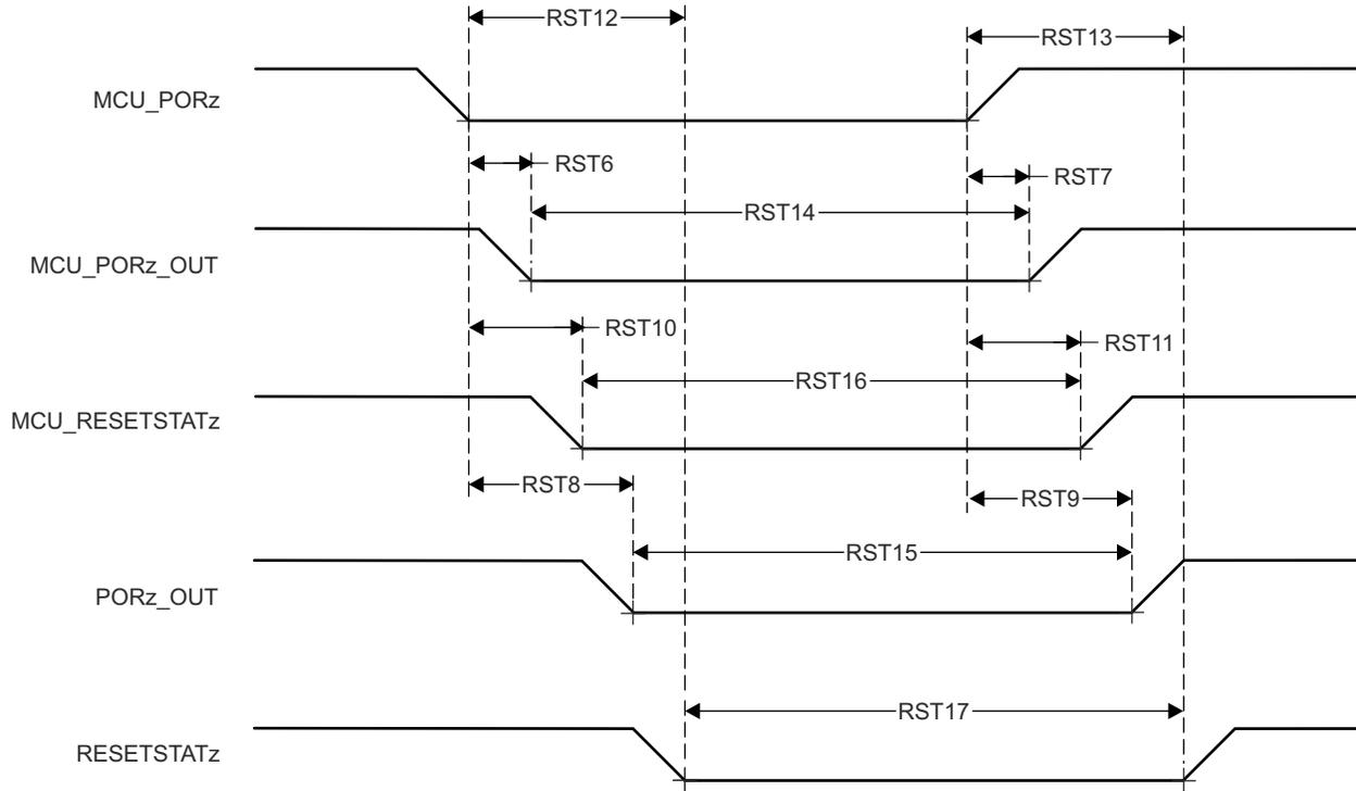
**図 6-14. MCU\_PORz 開始、MCU\_PORz\_OUT、PORz\_OUT、MCU\_RESETSTATz、RESETSTATz のスイッチング特性**
