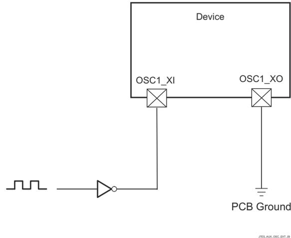
図 6-34. 1.8V LVCMOS 互換クロック入力
