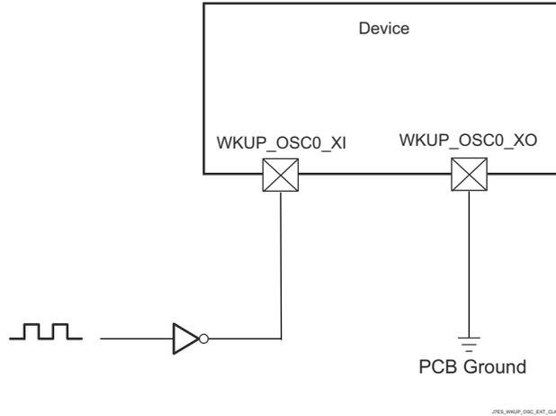
図 6-29. 1.8V LVCMOS 互換クロック入力
