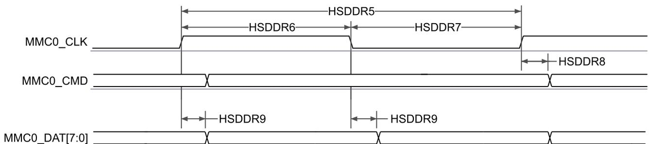
**図 6-84. MMC0 – 高速 DDR モード – 送信モード**
