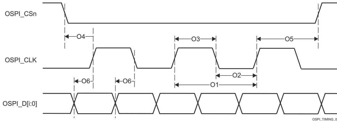
図 6-109. OSPI のスイッチング特性 – DDR
