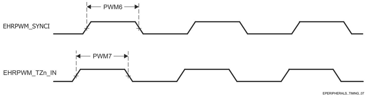
図 6-48. ePWM\_SYNCI および ePWM\_TZn\_IN の出力タイミング
