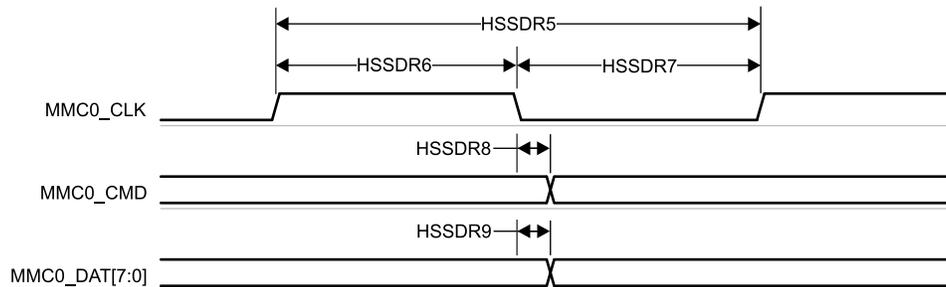
図 6-82. MMC0 – 高速 SDR モード – 送信モード
