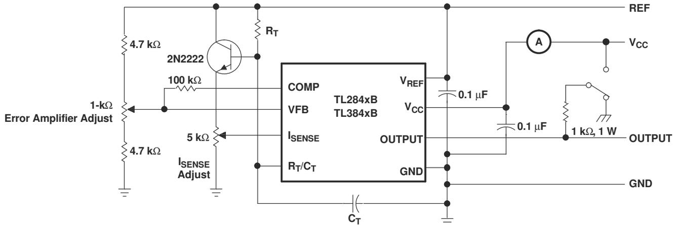
図 7-6. Open-Loop Laboratory Test Fixture
