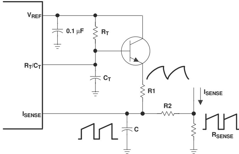
図 7-5. Slope Compensation
