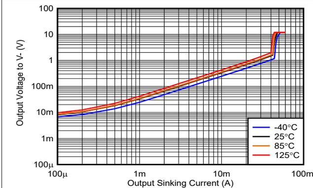
図 6-5. 出力電圧とシンク電流の関係、12V
