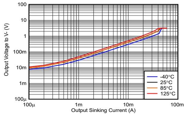
図 6-4. 出力電圧とシンク電流の関係、3.3V
