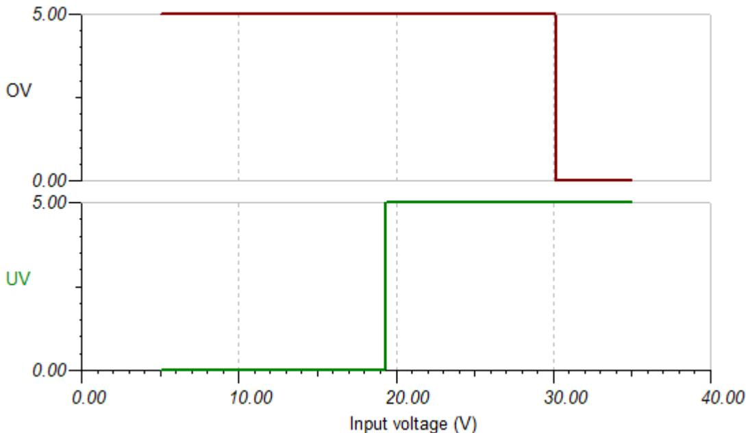
図 8-3. ウィンドウ コンパレータの結果
