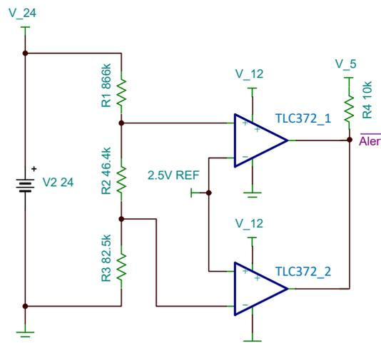
図 8-2. ウィンドウ コンパレータ
