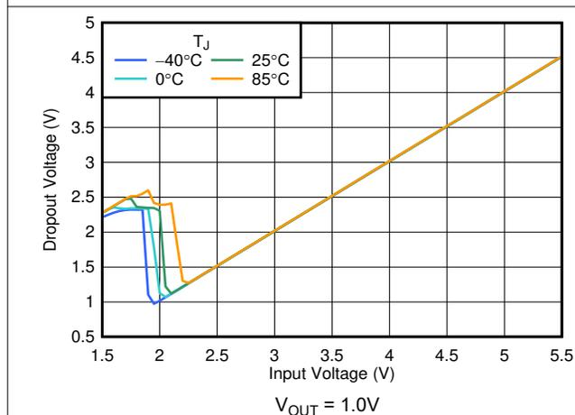
図 5-5. ドロップアウト電圧と  $V_{IN}$  との関係
