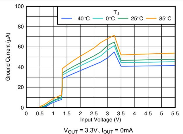
図 5-10.  $I_{GND}$  と  $V_{IN}$  との関係
