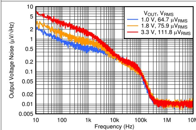
図 5-17. 出力ノイズと周波数および  $V_{OUT}$  との関係
