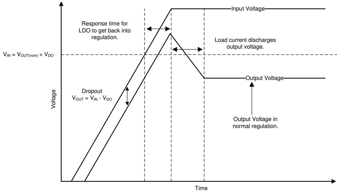
図 7-1. ドロップアウトへの起動
