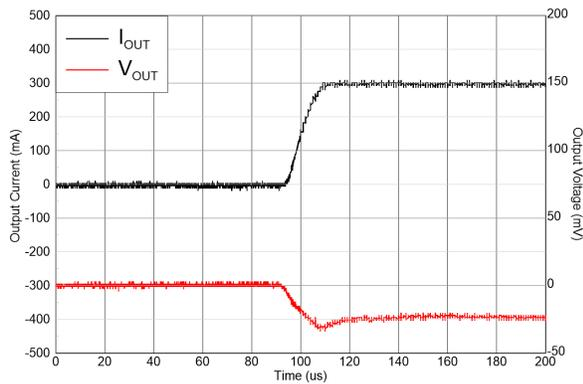
$V_{IN} = V_{OUT(nom)} + 1.0\text{V}$ 、 $I_{OUT} = 1\text{mA} \sim 300\text{mA}$ 、 $t_{RISING} = 10\mu\text{s}$
