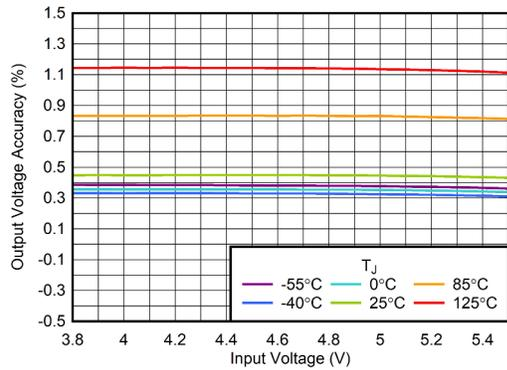
図 5-3. 出力電圧精度と  $V_{IN}$  との関係
