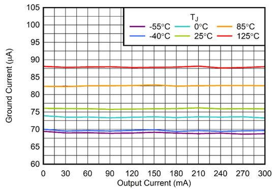
図 5-7. グランド電流 vs  $I_{OUT}$
