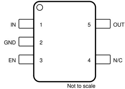
図 4-2. DBV パッケージ、5 ピン SOT-23 (上面図)
