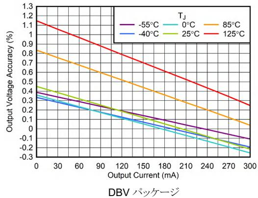
図 5-4. 出力電圧精度と  $I_{OUT}$  との関係
