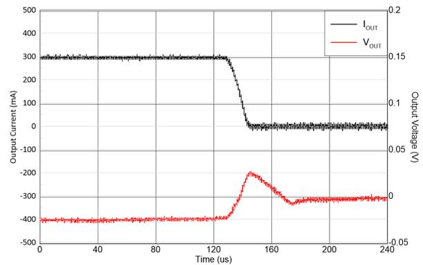
$V_{IN} = V_{OUT(nom)} + 1.0\text{V}$ 、 $I_{OUT} = 300\text{mA} \sim 1\text{mA}$ 、 $t_{FALLING} = 10\mu\text{s}$
