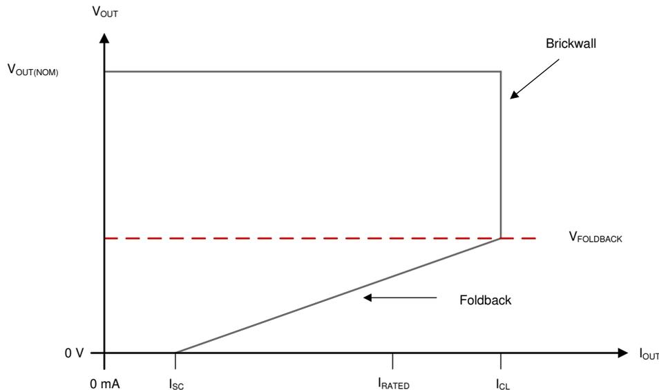
図 6-1. フォールドバック電流制限
