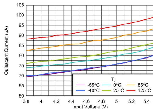
図 5-6. 静止電流と  $V_{IN}$  との関係
