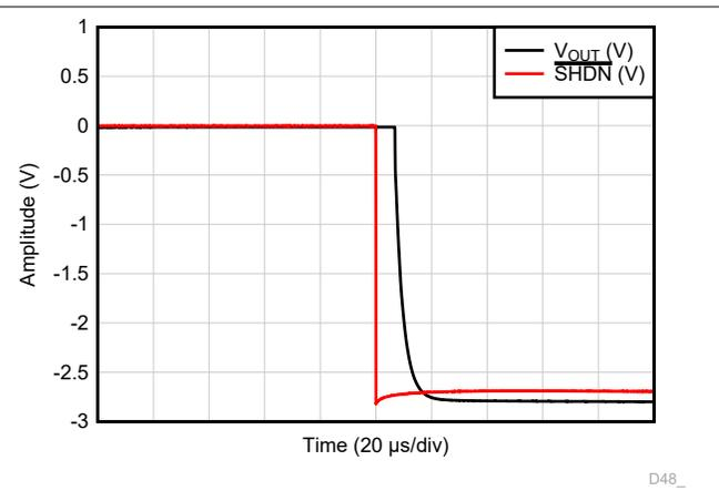
図 6-44. アンプのディセーブル応答
