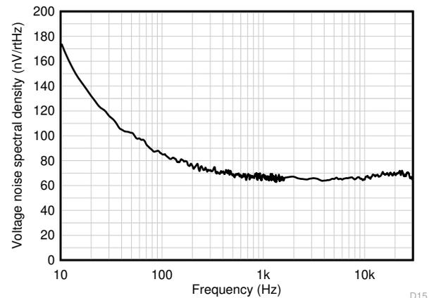
図 6-22. 入力電圧ノイズスペクトル密度
