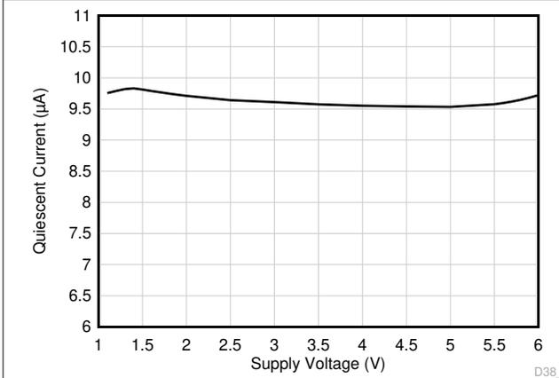
図 6-27. 静止電流と電源電圧との関係
