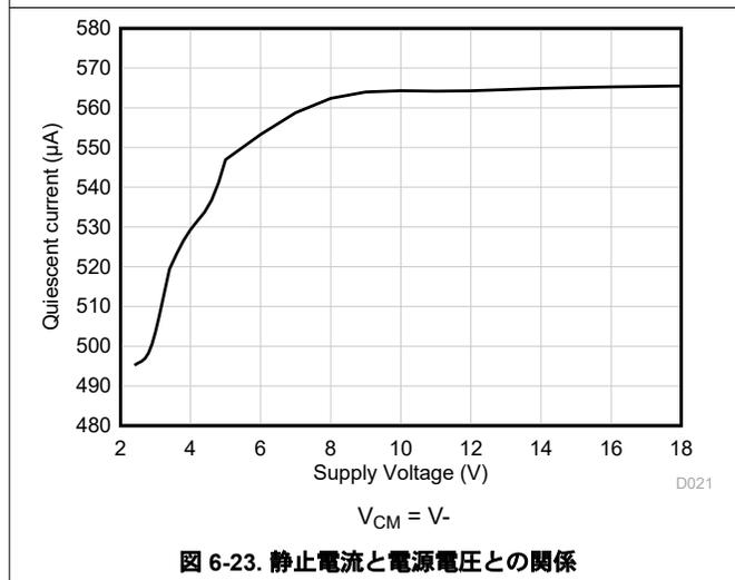
図 6-23. 静止電流と電源電圧との関係
