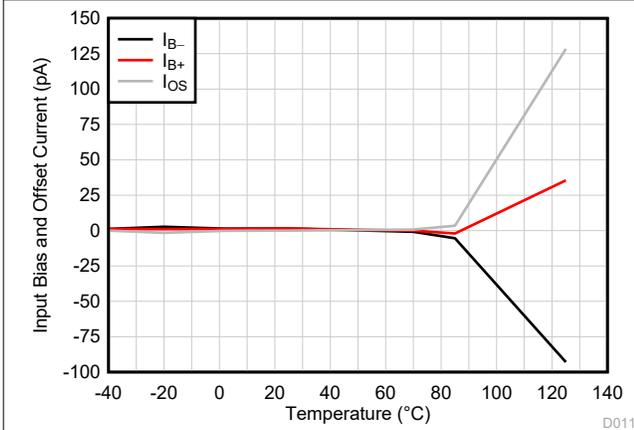
図 6-13. 入力バイアス電流と温度との関係
