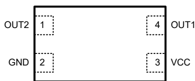
図 5-2. ZFC パッケージ、4 ピン X1LGA (上面図)
