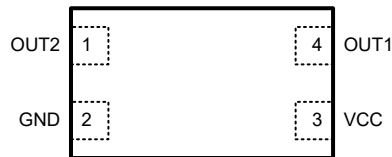
図 5-2. ZFC パッケージ、4 ピン X1LGA (上面図)
