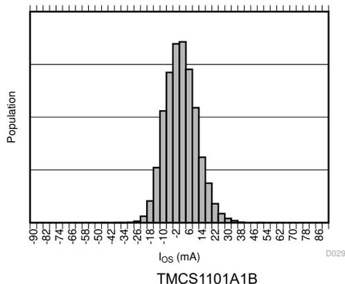
図 6-9. 入力オフセット電流の製品分布
