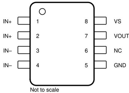
図 5-1. D パッケージ 8 ピン SOIC 上面図
