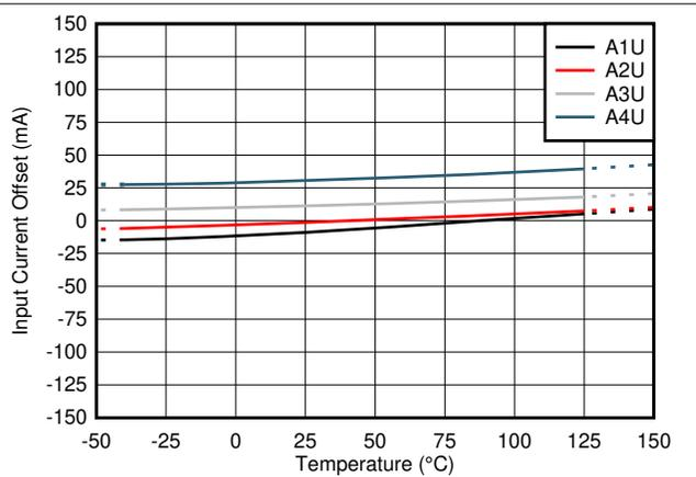
図 6-4. TMCS1101AxU の入力オフセット電流と温度との関係
